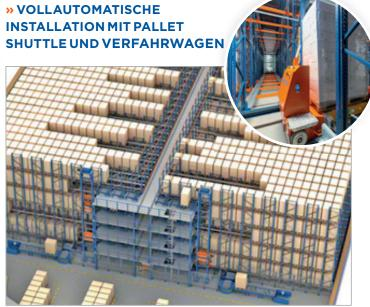
Das Regalbediengerät bewegt sich von den Ein- und Ausgangspositionen des Lagers bis hin zu einem beliebigen Lagerkanal. Das Pallet Shuttle ist für die Umladung der Paletten, aus dem Schlitten des Regalbediengerätes bis zu ihrer Platzierung im entsprechenden Kanal, verantwortlich. Im Allgemeinen werden zwei Blöcke mit Regalanlagen pro Verdichtung installiert, einer auf jeder Seite des Gangs.
