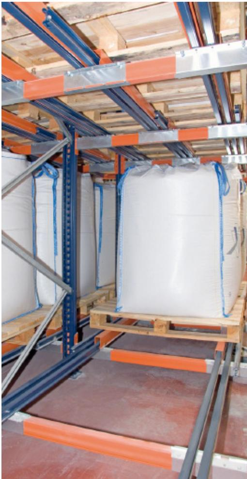
Das Push-back-System besteht einerseits aus gemeinsamen Elementen von Metall-Palettenregalanlagen (wie Rahmen, Längsträger, Horizontalstreben, Diagonalstreben, Verankerungen usw.), unterscheidet sich von diesen jedoch durch die Laufschiene, die Wagen und verschiedene Sicherheitsvorrichtungen:
