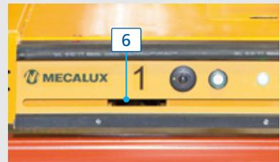
**Sicherheitsscanner (optional) (6):** Dieser wird auf jeder Seite des Pallet Shuttles angebracht, um den Zugang zu den Kanälen mit größerer Sicherheit zu steuern, während der Wagen in Betrieb ist.
