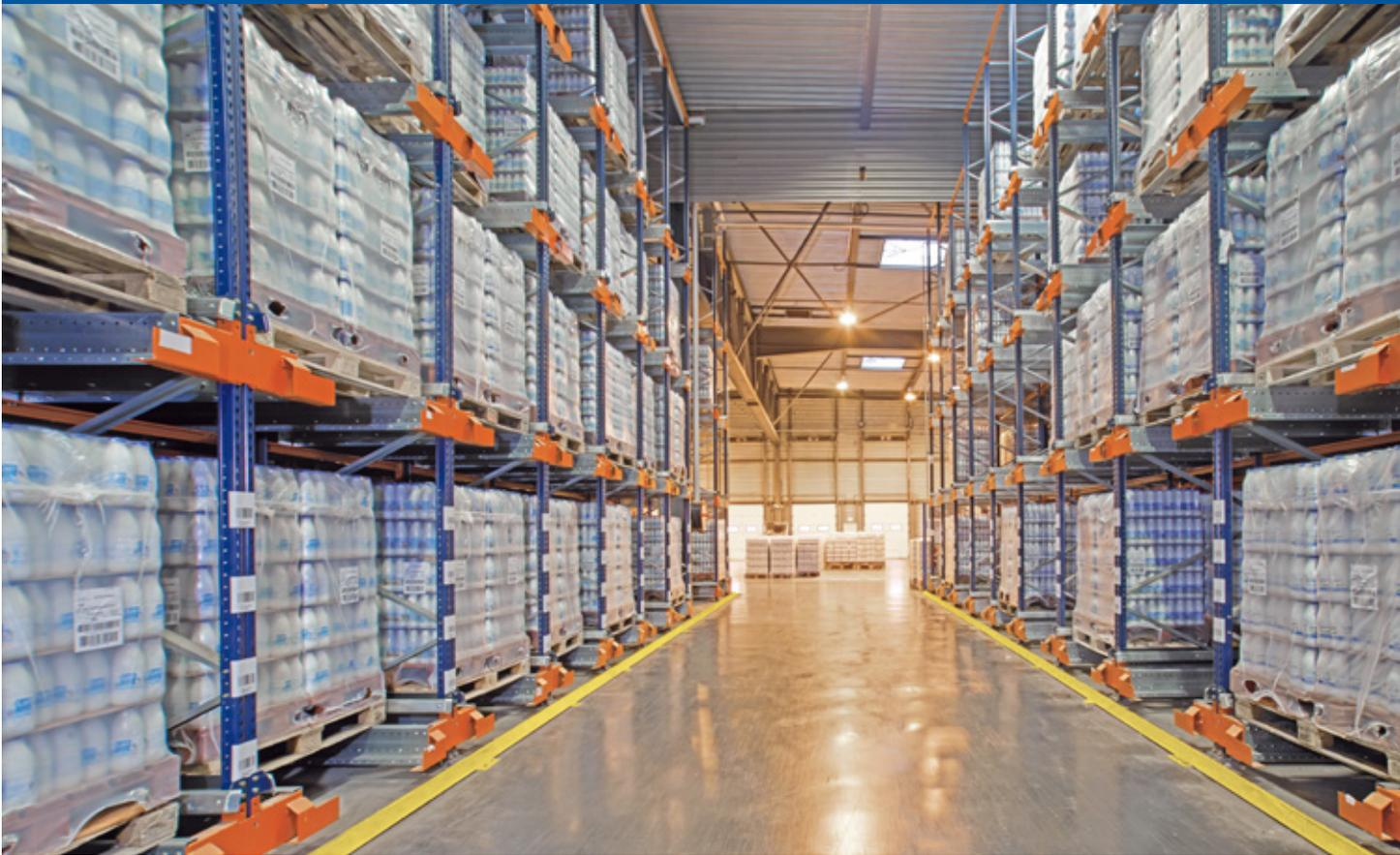
Bei den halbautomatischen Installationen mit Pallet Shuttle platzieren die Gabelstapler die Paletten auf den Schienen am Eingang der Ebene. Der elektrische Wagen holt diese ab und befördert sie an die erste freie Stelle im Kanal, sodass die Waren maximal verdichtet werden.
