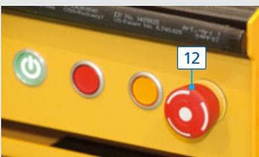
**Not-Aus-Schalter (12):** Er gewährleistet den Stillstand des Pallet Shuttles bei präventiven Wartungsmaßnahmen.
