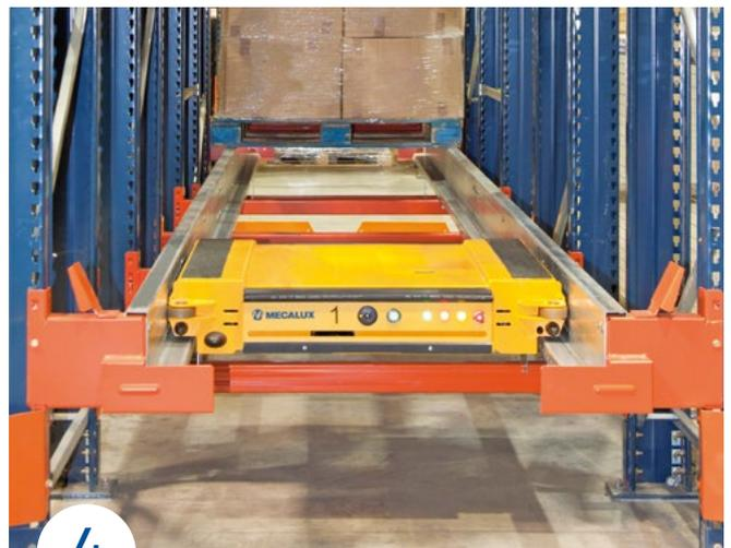
Das Shuttle kehrt zum Kanaleingang zurück und wiederholt den Vorgang, bis der gesamte Kanal gefüllt ist. Bevor der letzte freie Palettenstellplatz befüllt wird, wird das Shuttle entnommen und die Abfolge wiederholt sich im nächsten Kanal, in dem gearbeitet werden soll.
