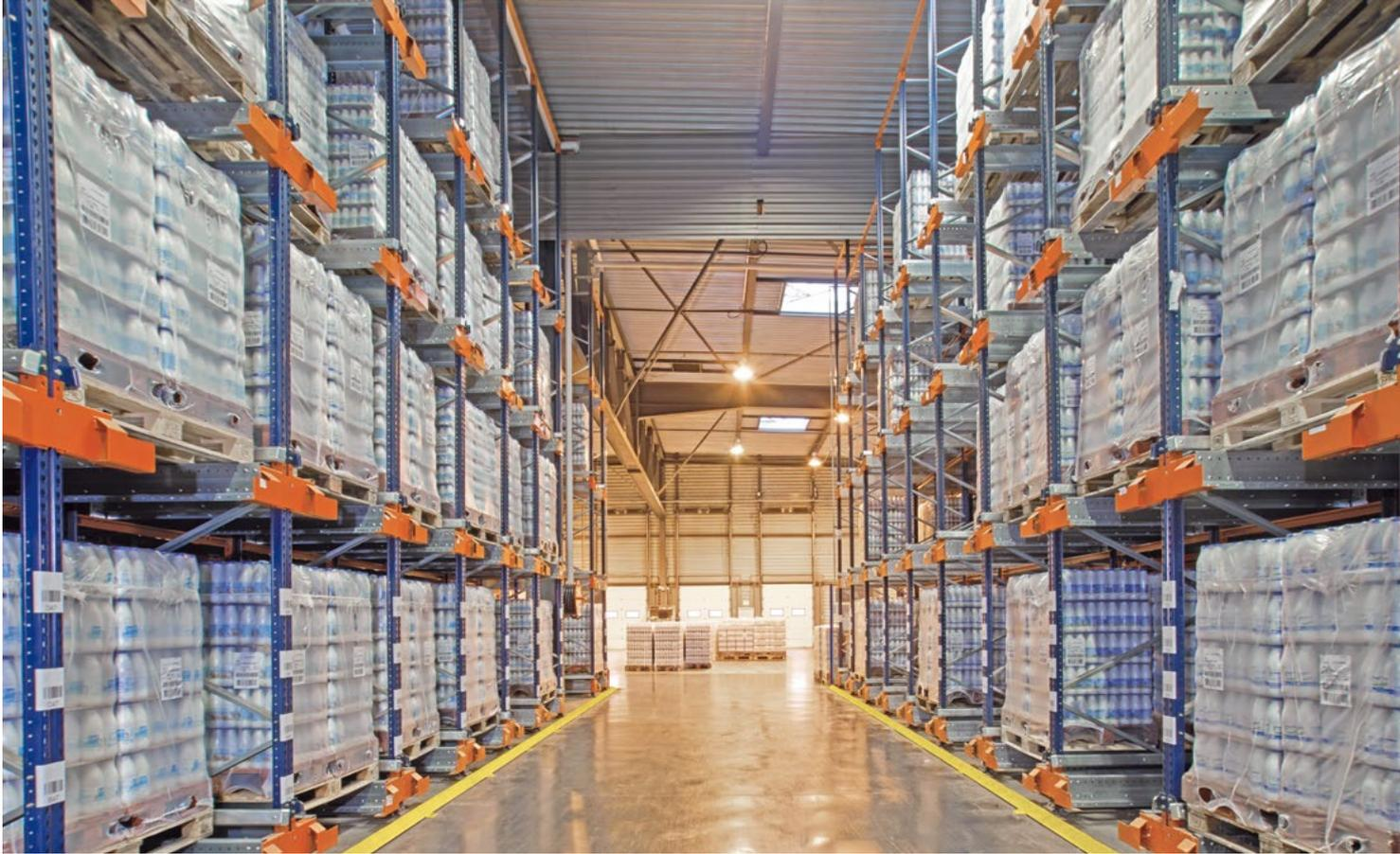
Bei den halbautomatischen Anlagen mit Pallet Shuttle platzieren die Gabelstapler die Paletten auf den Schienen am Eingang der Ebene. Das elektrische Shuttle holt diese ab und befördert sie in den ersten freien Stellplatz im Kanal, sodass die Waren maximal verdichtet werden.
