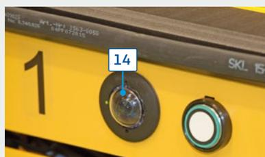
**Positionskamera (14, optional):** Hilft dem Bediener beim Zentrieren des Shuttles zwischen die beiden Schienen.
