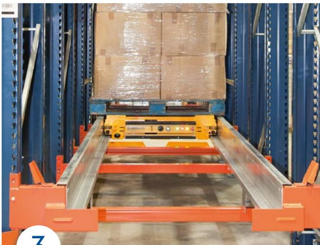
Über das mit dem WLAN verbundene Tablet gibt der Bediener den entsprechenden Befehl ein, woraufhin das Shuttle den Einlagerungsvorgang einleitet. Sobald die Palette identifiziert ist, hebt das Shuttle die Palette leicht an und bewegt sie dann in den Regalkanal hinein, bis sie den ersten freien Stellplatz erreicht, wo sie abgesetzt wird. Mehrere Sensoren steuern präzise die Bewegung des beladenen Shuttles.
