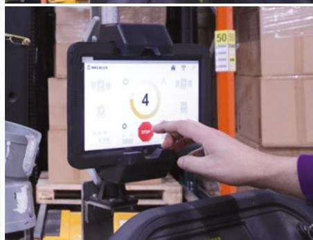
Um den Tablet-PC von einer ergonomischen und sicheren Position aus bedienen zu können, ist eine Halterung erhältlich, die direkt am Schutzrahmen des Gabelstaplers befestigt wird, entweder oben (am Dach) oder an einem der senkrechten Stützprofile. Der Tablet-PC kann dann in die Halterung gesetzt und leicht wieder herausgenommen werden.
