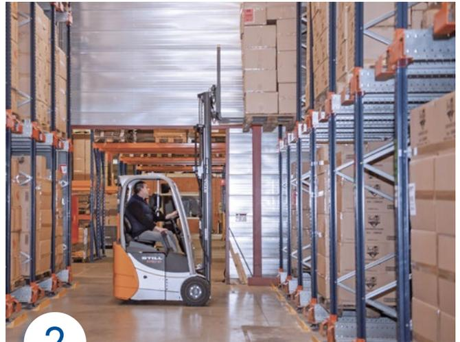
Daraufhin werden die Paletten mithilfe des Gabelstaplers einzeln am Kanaleingang auf die Schienen platziert. Der Gabelstapler fährt niemals in die Regalstruktur hinein.
