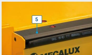
**Sicherheitsleiste (5):** Sie befinden sich an der Vorder- und Rückseite des Shuttles, um ein Einklemmen oder Quetschen zu verhindern.
