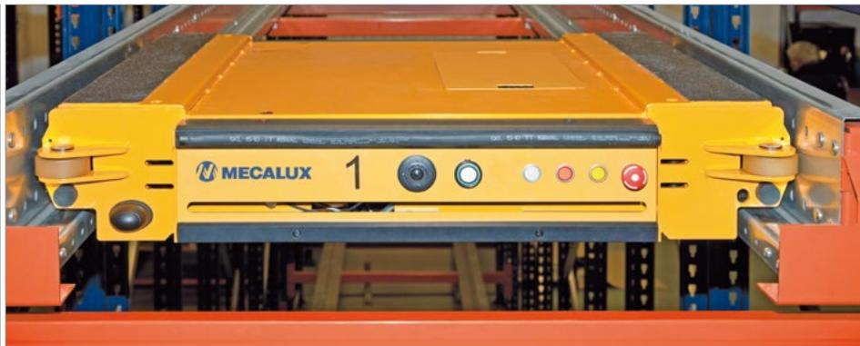
Die **Lithium-Akkus** sind **leicht zugänglich** und **kabellos**, weshalb sie schnell gewechselt werden können, ohne den Arbeitszyklus zu unterbrechen.
