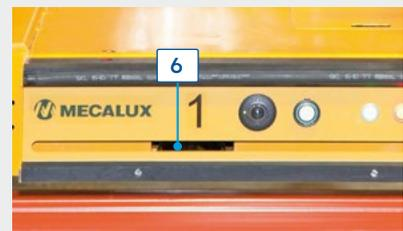
**Sicherheitsscanner (6, optional):** Befindet sich auf beiden Seiten des Shuttles, um die Sicherheit in den Kanälen zu gewährleisten.
