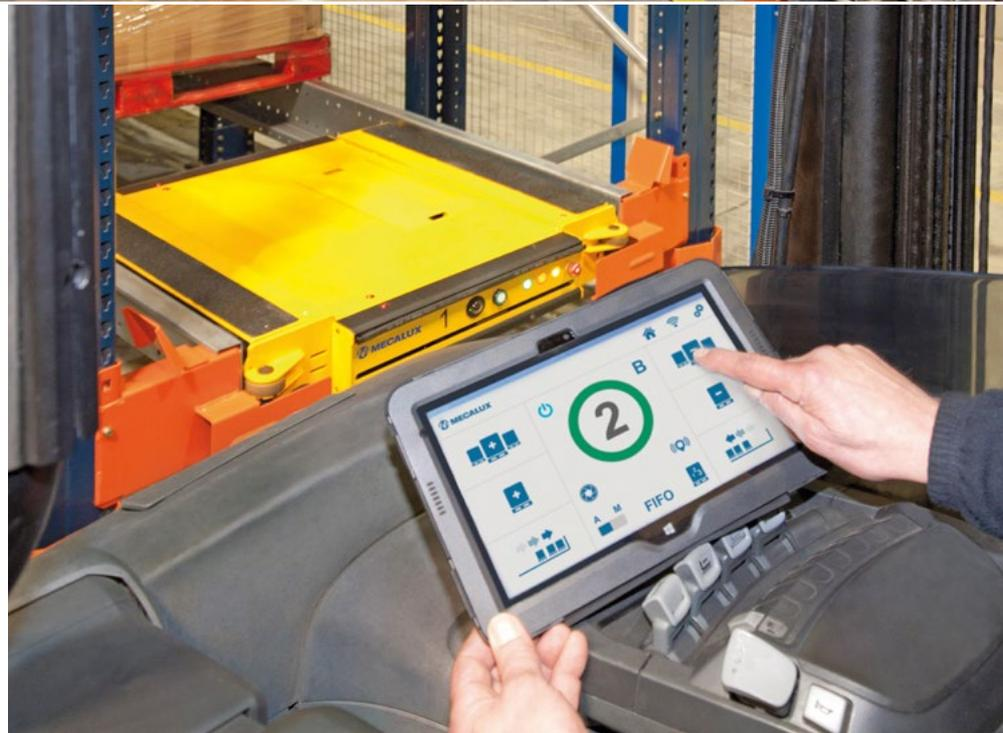
Das mit WLAN-Verbindung ausgestattete Tablet verfügt über eine intuitive Benutzeroberfläche.
