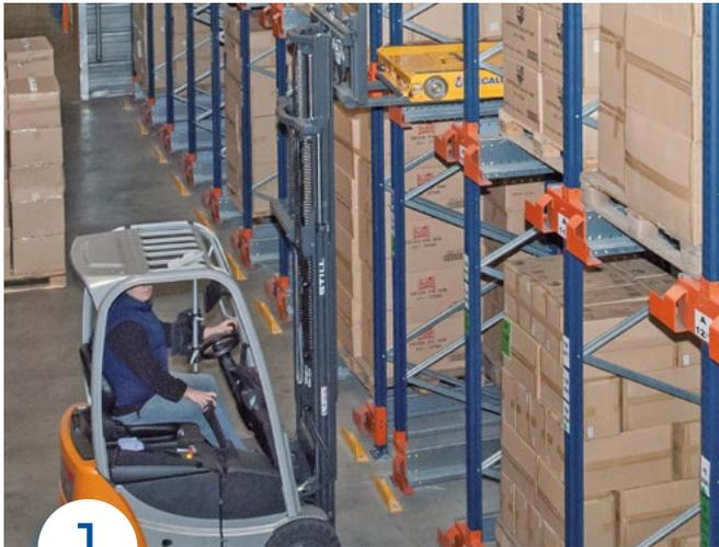
Der Gabelstapler hebt das Shuttle an und setzt es in den Schienen des Kanals ab.
