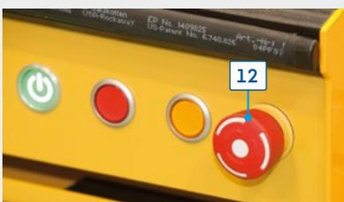
**Not-Aus-Schalter (12):** Hält den Shuttle sofort an und muss vor der Durchführung von Wartungsarbeiten unbedingt betätigt werden.
