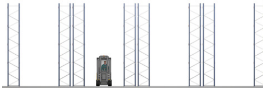
Die am weitesten verbreitete Variante von Palettenregalen besteht aus Einfachregalen an der Wand und zentralen Doppelregalen
