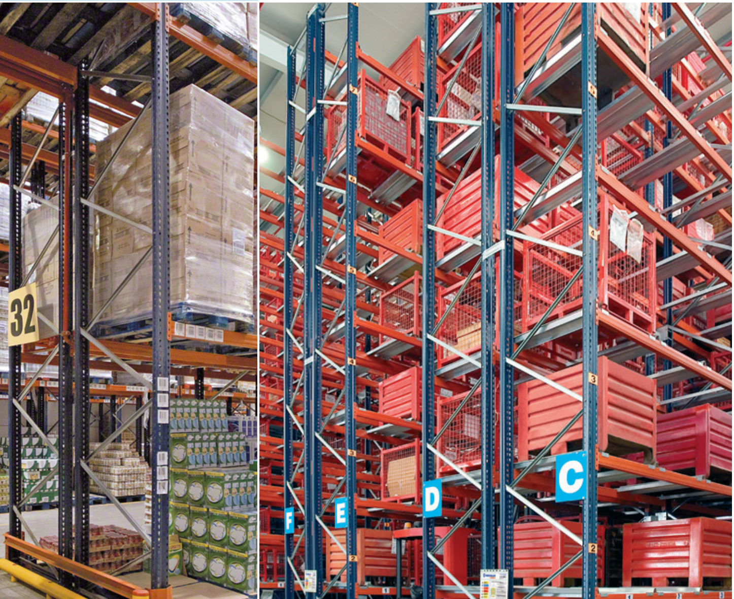
Palettenregalanlage mit Stahlbehältern
