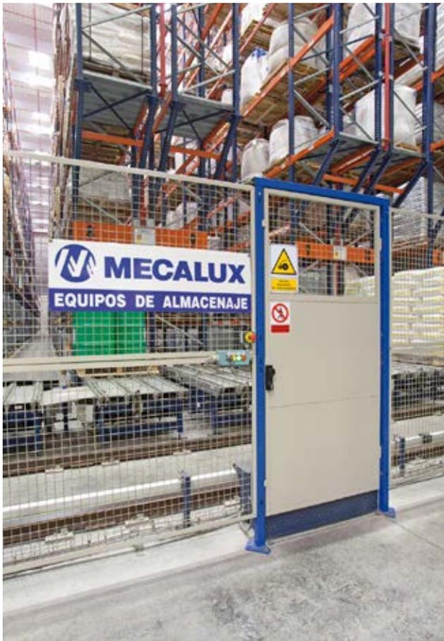
Hierbei handelt es sich um senkrechte Gitterwände und Türen mit Vorrichtungen zur Zugangskontrolle. Ihre Hauptfunktion besteht darin, die Gefahrenzonen des Förderkreislaufs abzugrenzen, um Unfälle zu vermeiden.
