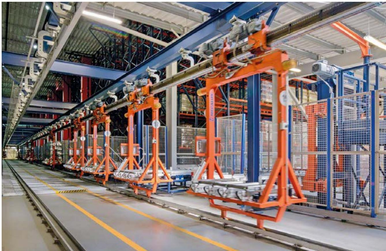
Schienengeführte Fördersysteme sind Unstetigfördersysteme, die aus automatisierten bzw. selbstfahrenden Wagen bestehen und sich über elektrischen Schienen bewegen, die einen geschlossenen Kreislauf bilden. Eine variable Anzahl von Wagen durchläuft den Kreislauf und transportiert die Paletten zwischen den verschiedenen Stationen oder Haltepunkten gemäß den Anweisungen, die sie von den entsprechenden Verwaltungs- und Steuerungsprogrammen erhalten.
