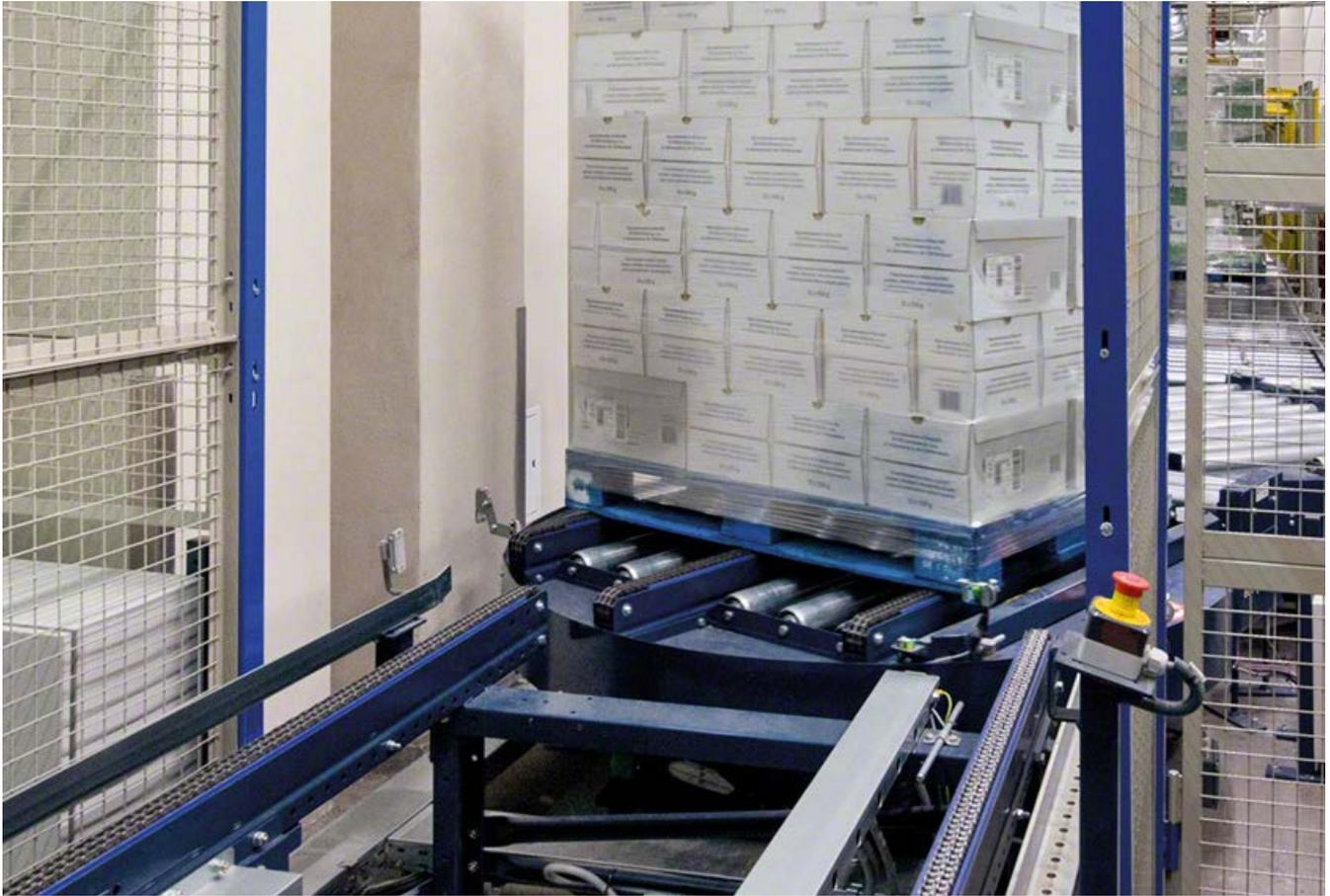
Der Drehtisch mit Rollen und Ketten ermöglicht es, die Bewegungsrichtung der Palette sowie die Transportausrichtung zu ändern, mit der Möglichkeit, bei geraden Strecken von Ketten auf Rollen oder umgekehrt zu wechseln.
