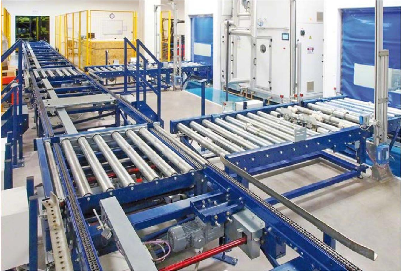
Kombination aus Rollen- und Kettenförderer, der eine Änderung der Bewegungsrichtung bzw. der Ausrichtung der Palette ermöglicht. Die Rollen sind fest an einem Rahmengestell montiert, während die Ketten an einem Hubrahmen befestigt werden. Damit diese Kombination einwandfrei funktioniert, liegt der Kettenförderer stets 50 mm höher als der Rollenförderer.
