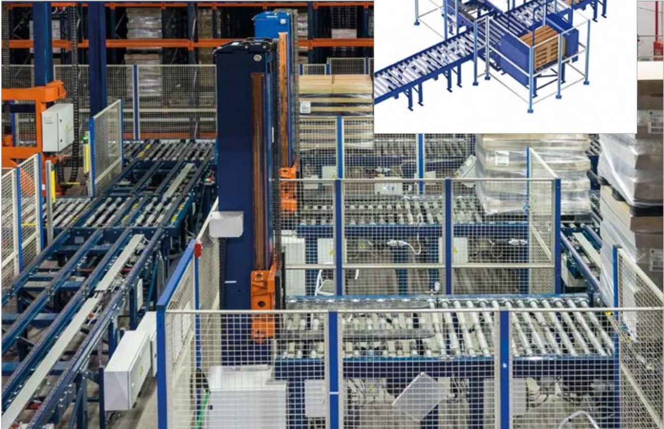
Zusatzgerät für Fördersysteme, das dazu dient, eine Palette bzw. Halbpaletten auf eine andere zu setzen.
