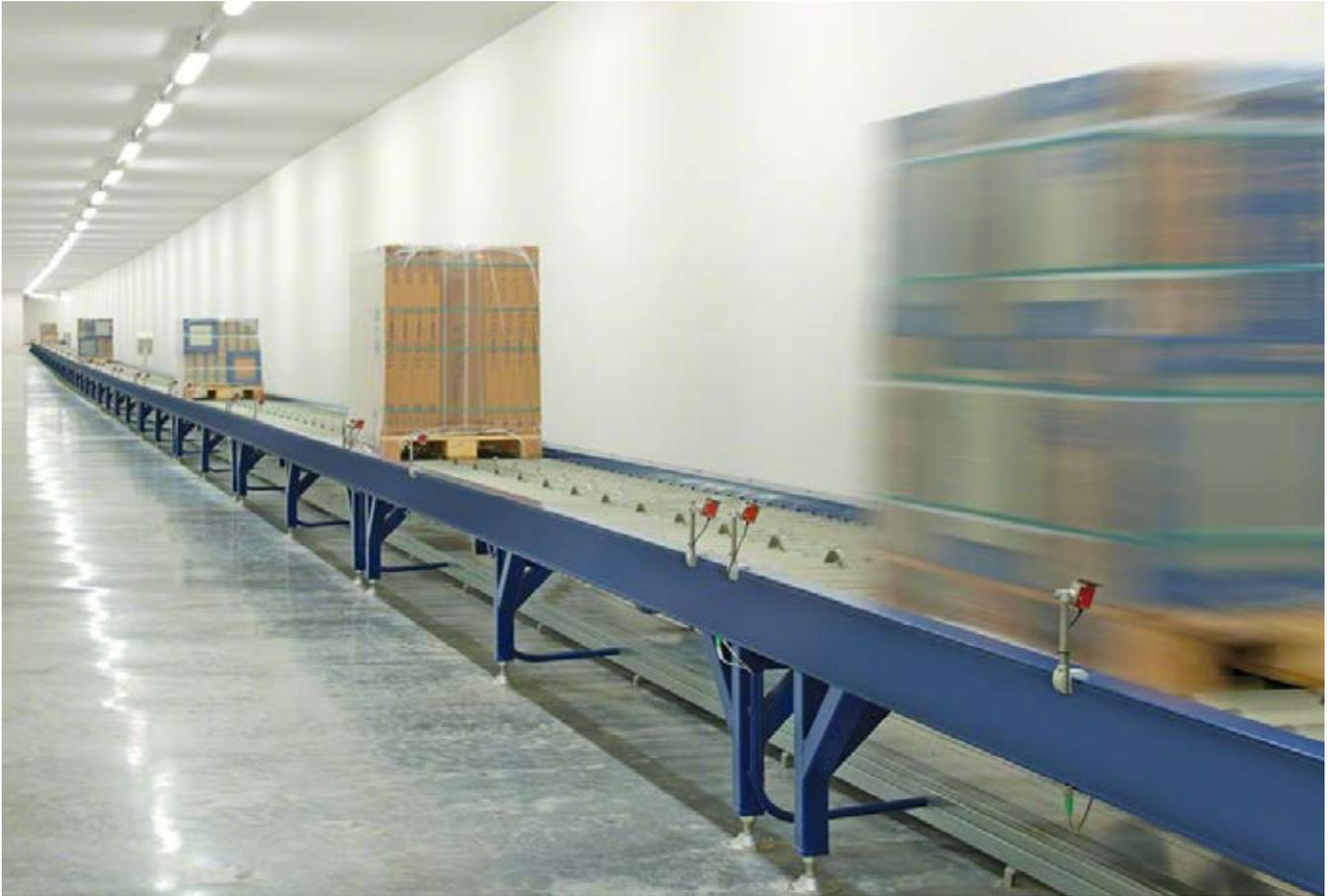
System aus gekuppelten Rollen, das das Stauen mehrerer Paletten erleichtert und so Material- und Wartungskosten senkt. Es sorgt für eine gleichmäßige Bewegung der Last und ist in der Lage, bis zu 16 Paletten auf einer von einem einzigen Motor angetriebenen Linie oder vier parallelen Linien mit jeweils bis zu vier Paletten zu transportieren.
