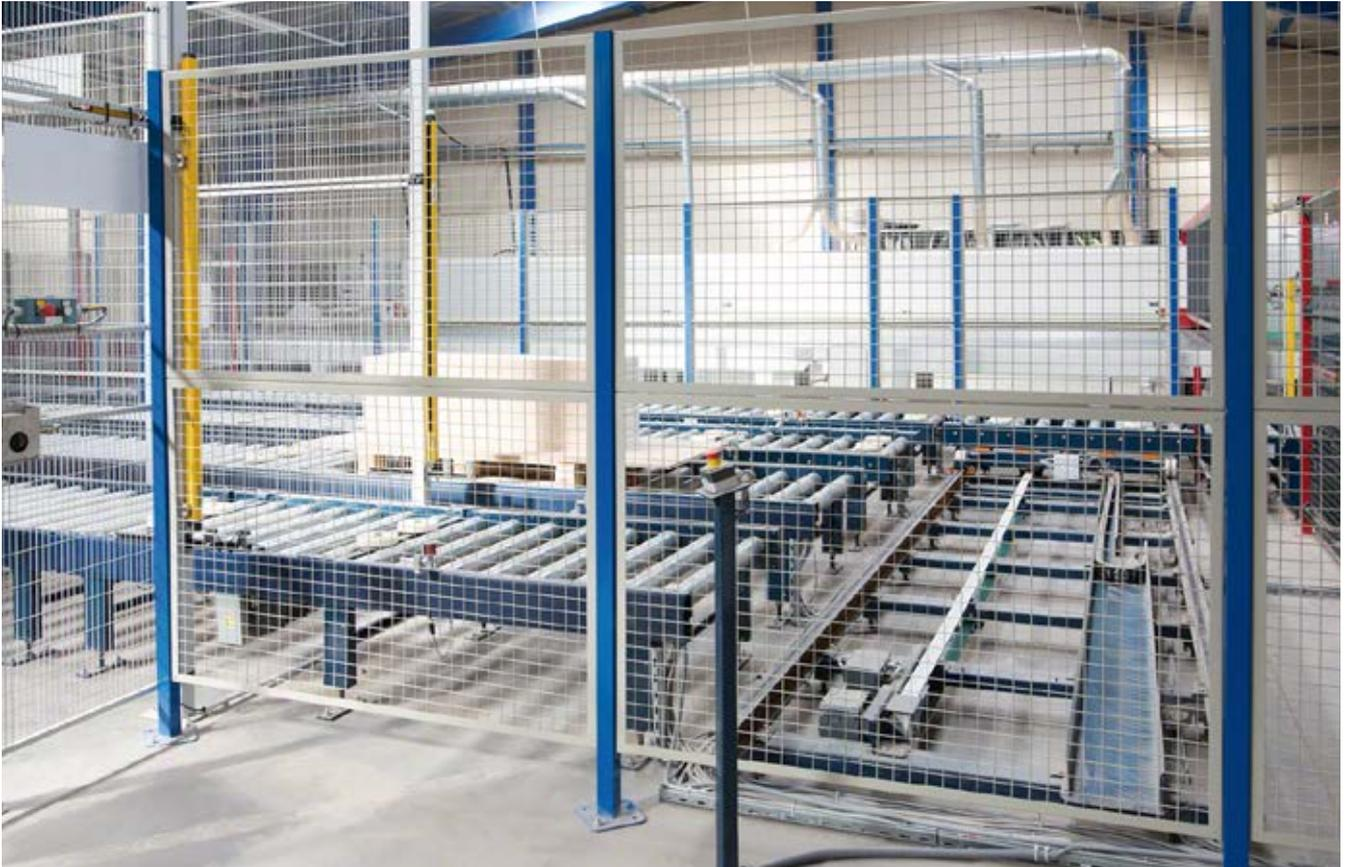
Dieser auf Schienen montierte Wagen führt kurze Längsbewegungen aus, die verschiedene Be- und Entladepunkte miteinander verbinden. Im oberen Teil verfügt er über eine Fördervorrichtung mit Rollen oder Ketten, die eine Palette aufnehmen kann.
