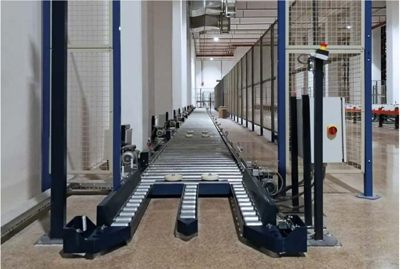
Führt Bewegungen in Längsrichtung auf Bodenebene zwischen verschiedenen Punkten innerhalb einer Anlage aus, wenn die lichte Höhe der Anlage unzureichend ist oder aufgrund von baulichen Hindernissen keine Grube angelegt werden kann.
