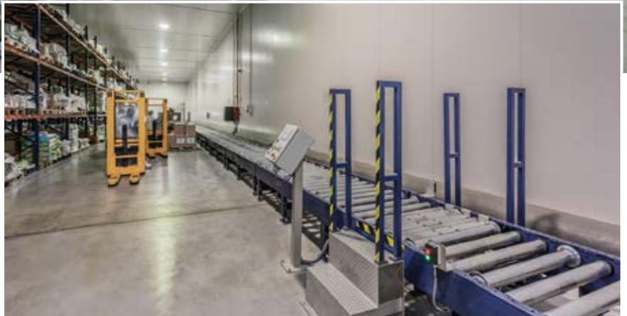
Es lassen sich unendlich viele Kreisläufe bauen, die sich an die unterschiedlichsten Anforderungen an den Transport von Paletten anpassen lassen. Dies ist, unabhängig von der Palettenlänge und davon, ob Höhenunterschiede innerhalb der Anlage zu bewältigen sind bzw. verschiedene Ebenen oder Durchgangsbereiche miteinander verbunden werden müssen, durch unterirdische Tunnel oder Hochtunnel möglich.
