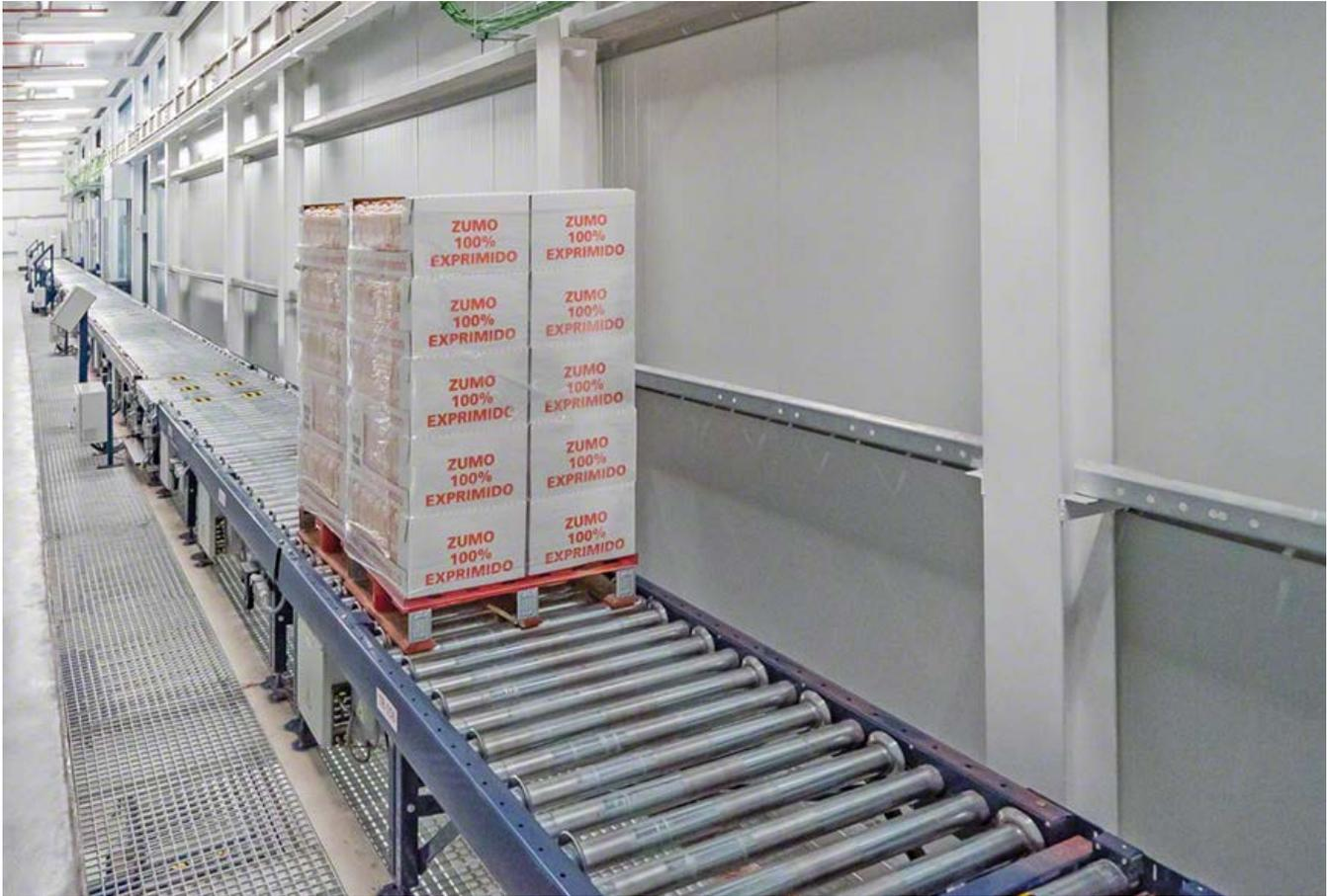
Dieses Förderelement ist in der Lage, mit geringem Aufwand Transporte in Längsrichtung durchzuführen, lange Strecken kostengünstig zu überwinden und Lasten zwischen mehreren Punkten innerhalb einer Anlage zu transportieren. Die Paletten werden mit den Kufen in Bewegungsrichtung, senkrecht zu den Rollen, transportiert.
