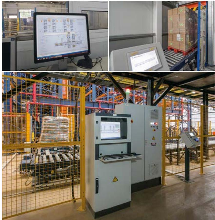
Externe Elemente wie Palettenheber, Packmaschinen, Shuttles usw. können integriert werden, sofern sie über ein eigenes Steuerungsprogramm oder eine einfache SPS verfügen. In diesem Fall senden oder empfangen die einfachen Förderer nur Signale bezüglich des Vorhandenseins oder der Beendigung einer Bewegung. Diese Version wird für kleine und unkomplizierte Anlagen empfohlen.
