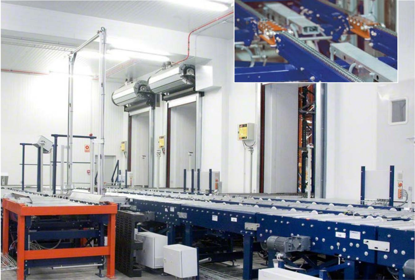
Wenn im Streckenverlauf eines Kreislaufs mit Kettenförderern ein Tor eingebaut werden muss, z. B. aus Gründen des Brandschutzes oder als Zugang zu Kühlbereichen, wird die Förderlinie unterbrochen und es entsteht eine 200 bis 300 mm breite Lücke zwischen den Förderern.
