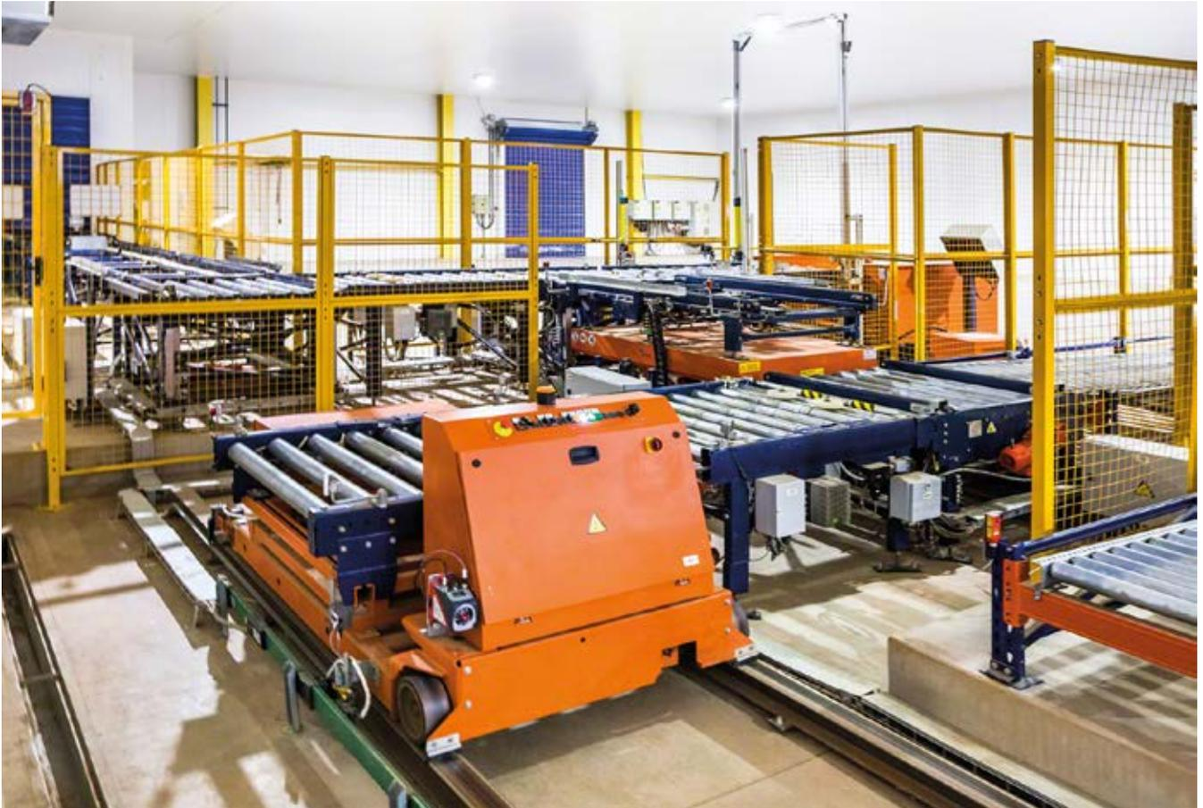
Nicht-kontinuierliches Fördersystem für Ladeinheiten. Es handelt sich um einen Wagen, der sich auf Schienen auf einer geraden Strecke bewegt und mehrere dazwischen liegende Punkte verbindet. Seine Länge lässt sich an die zu überbrückende Entfernung anpassen, da er auf unabhängigen Schienen montiert wird, die am Boden befestigt oder darin eingelassen sind.
