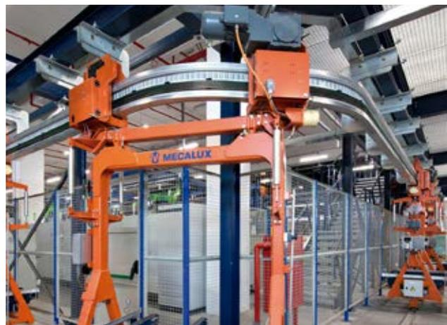
Die Höchstzahl der sich in Bewegung befindlichen Paletten in einem Kreislauf wird durch die Anzahl der vorhandenen Wagen begrenzt. Um Sammelbereiche zu schaffen, müssen Förderer in speziellen Bereichen installiert werden.
