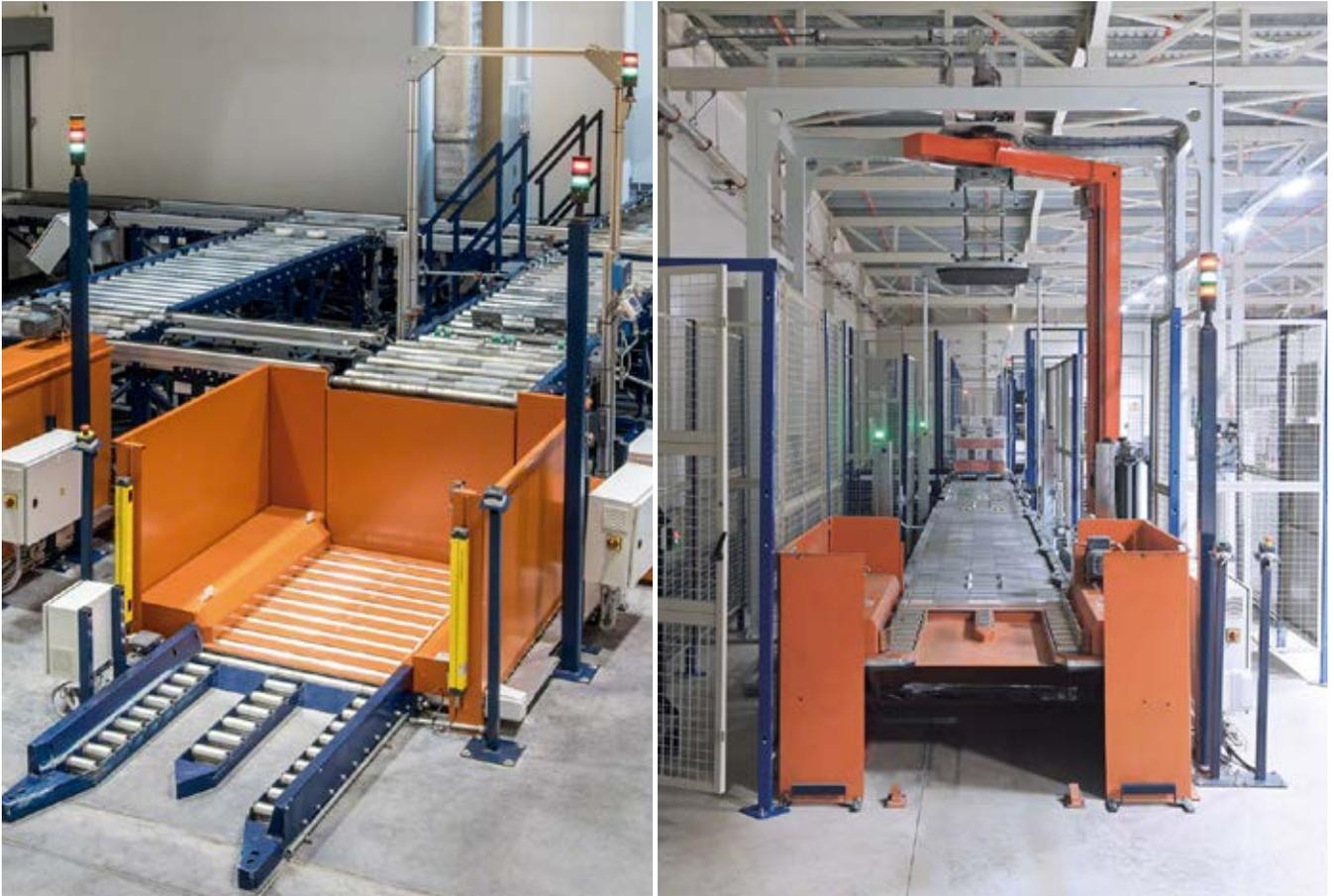
Dieses Element hebt die Ladeeinheit mithilfe eines hydraulischen Hubsystems von der Bodenebene bis auf die Höhe des Förderkreislaufs. Dieser Förderer ist in zwei Ausführungen erhältlich:
