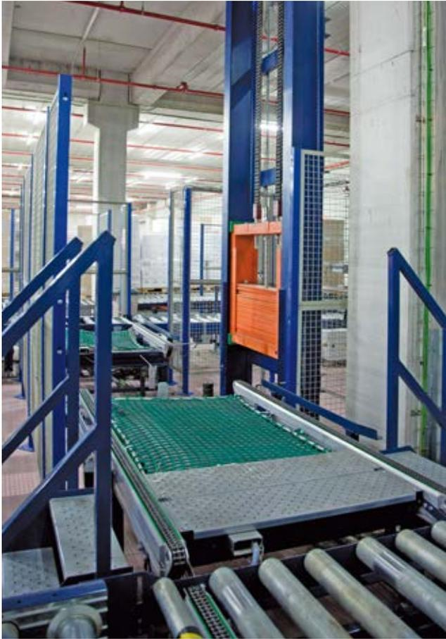
Bei Förderern, die Gängen mit in Bewegung befindlichen Maschinen zugewandt sind, können über entstehende Lücken horizontale Netze angebracht werden, um den Zugang zu den Maschinen zu verhindern.
