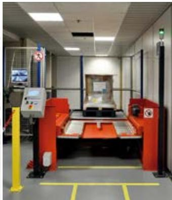
**Rollenförderer mit Führungswänden für die Beladung mit Palettenhubwagen.** Sie sind unerlässlich, um auf Bodenebene arbeiten zu können, wenn die Ware mit Palettenhubwagen gehandhabt wird, und sind mit oder ohne Hubfunktion lieferbar.
