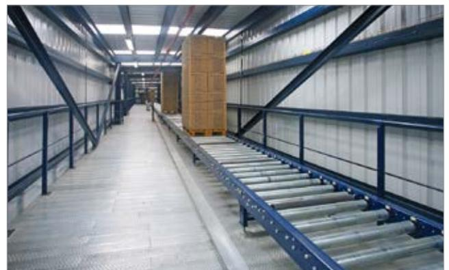
**Mechanischer Rollenförderer mit Staufunktion.** Sie können pro Transportabschnitt bis zu 16 Paletten mit einer Länge von je 1200 mm kontinuierlich transportieren oder stauen. Dies ist eine gute Option, um gerade Kreisläufe zu bilden und Paletten kontinuierlich zu stauen.
