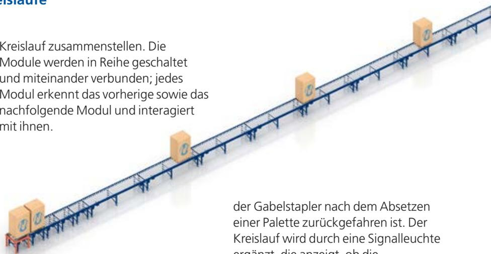
Das Element, das das erste Signal gibt, kann eine einfache manuelle Taste sein, die aktiviert werden muss, nachdem die Palette abgesetzt und der Gabelstapler zurückgefahren wurde, oder eine frontale Fotozelle, die die gleiche Funktion erfüllt. Eine andere Möglichkeit ist die Platzierung einer Induktionsschleife auf dem Boden, die das Signal aktiviert, nachdem
