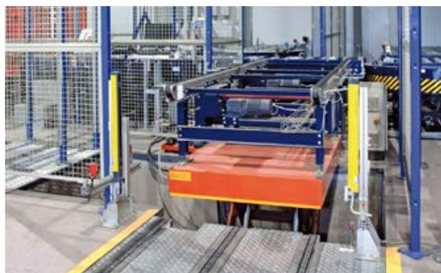
**Hubtisch für Fördervorrichtung.** Sie überwinden geringe Höhenunterschiede auf dem Boden und verändern so die Transporthöhe.
