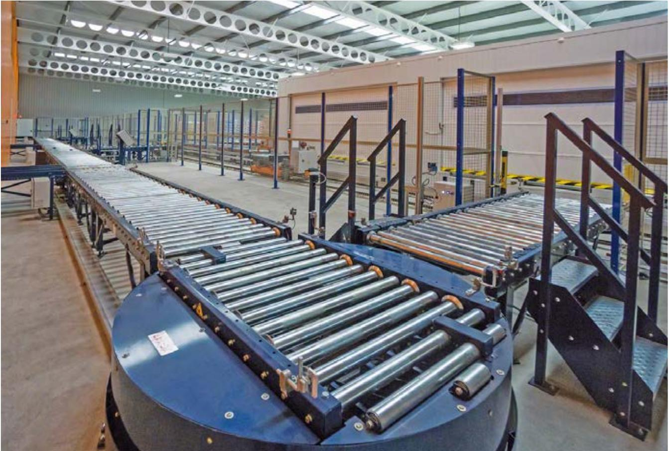
Der Drehtisch mit Rollen oder Ketten ermöglicht es, die Bewegungsrichtung der Palette zu ändern und die Ausrichtung der Last auf winkligen Strecken mit Förderern des gleichen Typs (Rollen oder Ketten) beizubehalten.
