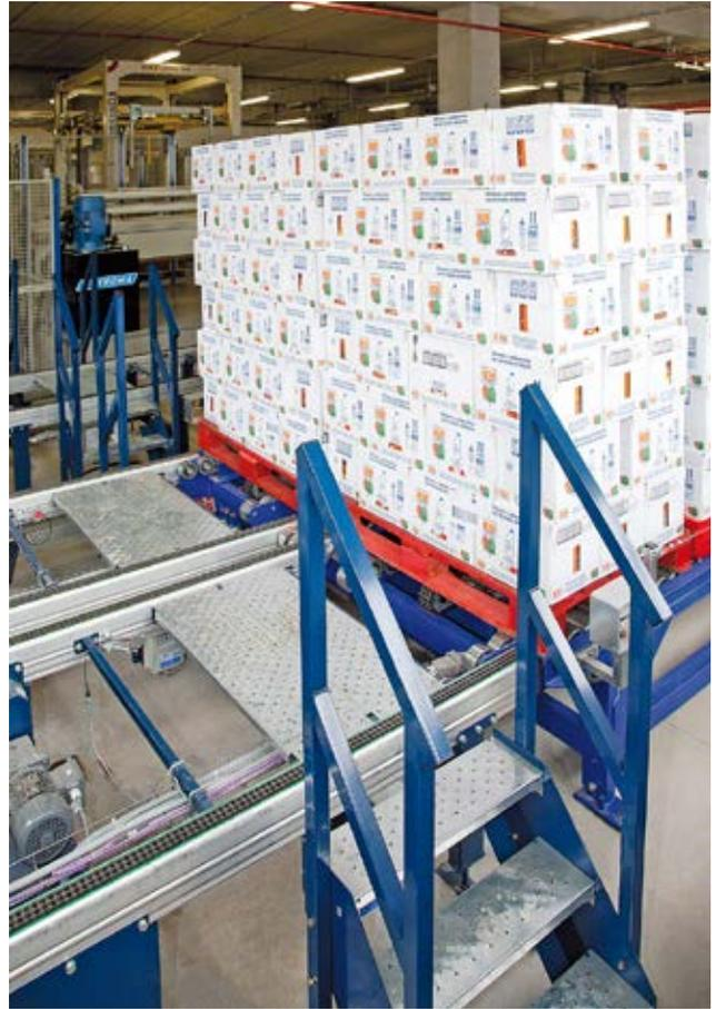
Feste Elemente, die es den Lagerarbeitern ermöglichen, den Förderkreislauf zu überqueren und bequem und sicher auf die andere Seite zu gelangen, ohne dass die Gefahr des Herunterfallens oder Einklemmens besteht.
