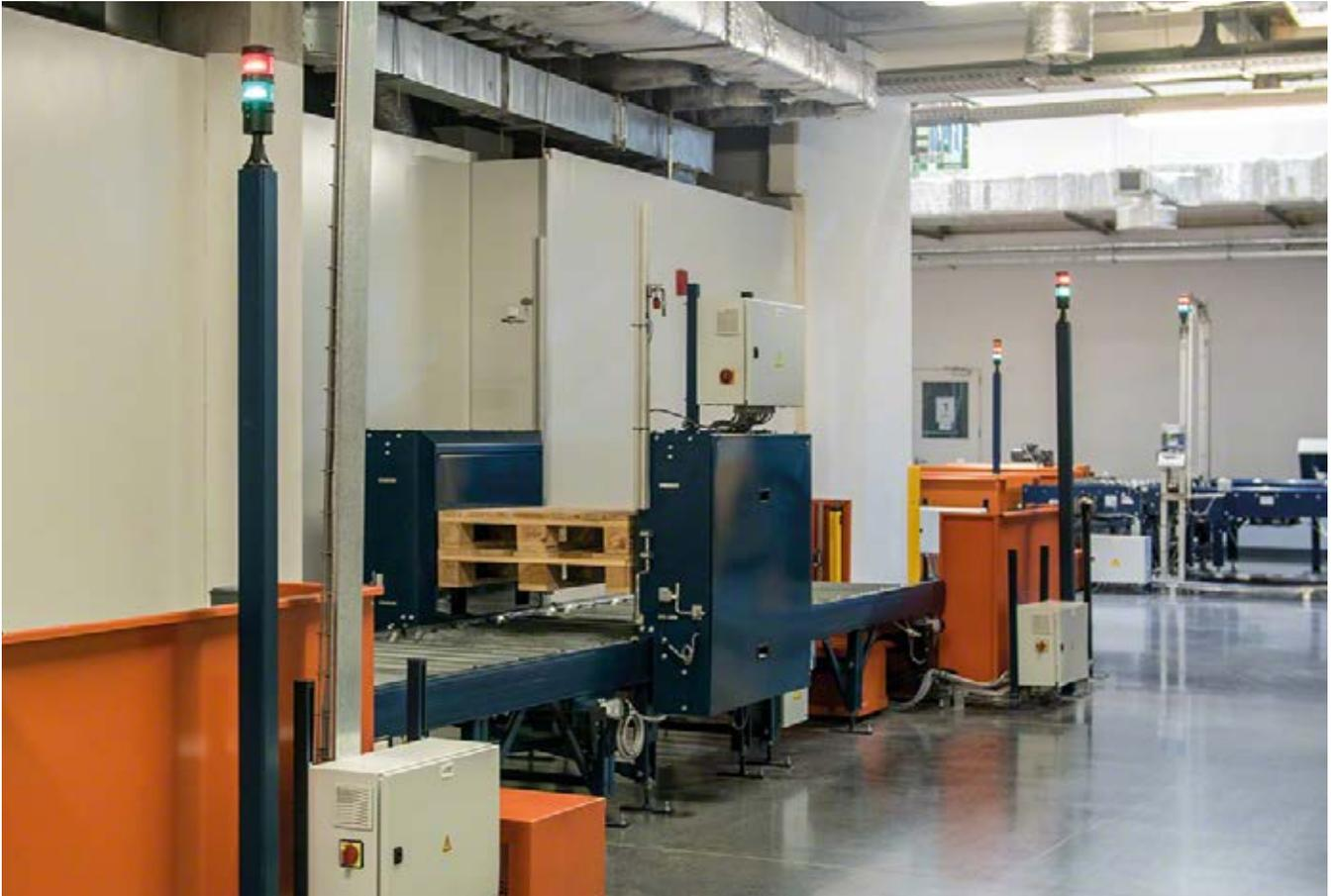
Ergänzung für automatisierte Fördersysteme, die die Lagerung von leeren Paletten oder deren Einbindung in den Kreislauf erleichtert.
