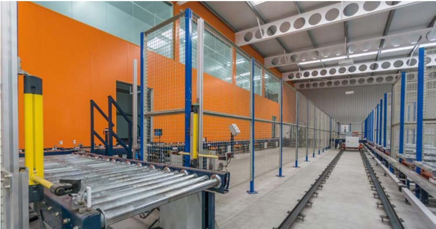
Die Kreisläufe werden durch Sicherheitsvorrichtungen wie Gitterwände und Türen mit Zugangskontrolle ergänzt, die einen maximalen Schutz für die Lagerarbeiter bieten.
