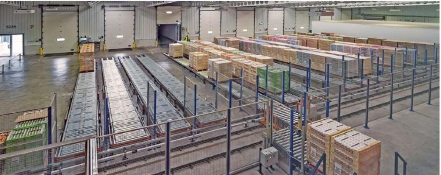
Die aus dem Lager oder den Kommissionierbereichen kommenden Paletten **werden mithilfe eines Shuttles in Kanälen zur Ladevorbereitung klassifiziert.**
