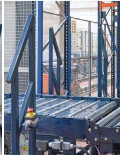
Mit diesen grundlegenden Förderermodellen lassen sich Kreisläufe mit ungeraden Streckenverläufen zusammensetzen, indem gerade Abschnitte mit Rollen- und Kettenmodulen kombiniert werden oder in dem alle Abschnitte aus Modulen der gleichen Art bestehen.
