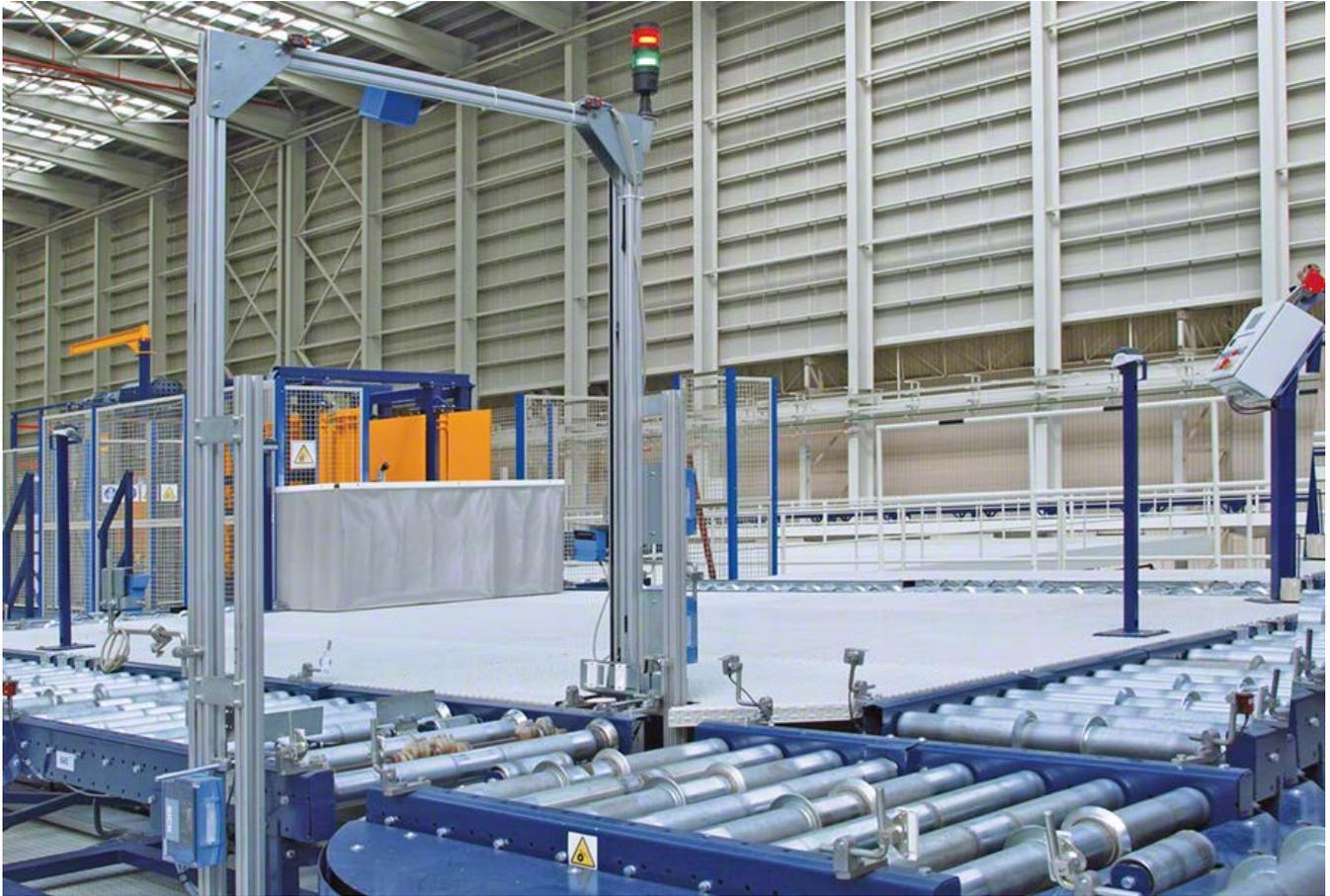
Die Palettenkontrollstation wird dann verwendet, wenn überprüft werden muss, ob die Abmessungen, das Gewicht und der Zustand der Paletten den Anforderungen der Einrichtung entsprechen, insbesondere wenn das Fördersystem für die Einlagerung von Paletten in einem automatisierten Lager eingesetzt wird.
