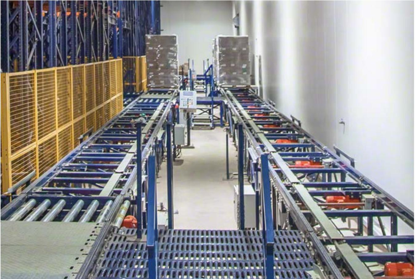
Element zum Transportieren von Paletten, wobei die Kufen quer zur Bewegungsrichtung ausgerichtet sind (die Europalette wird mit der 1200 mm langen Seite eingesetzt). Die Breite des Förderers ermöglicht den Transport aller Arten von Paletten. Für Halbpaletten ist ein spezielles Modul mit vier Kettensträngen erforderlich.
