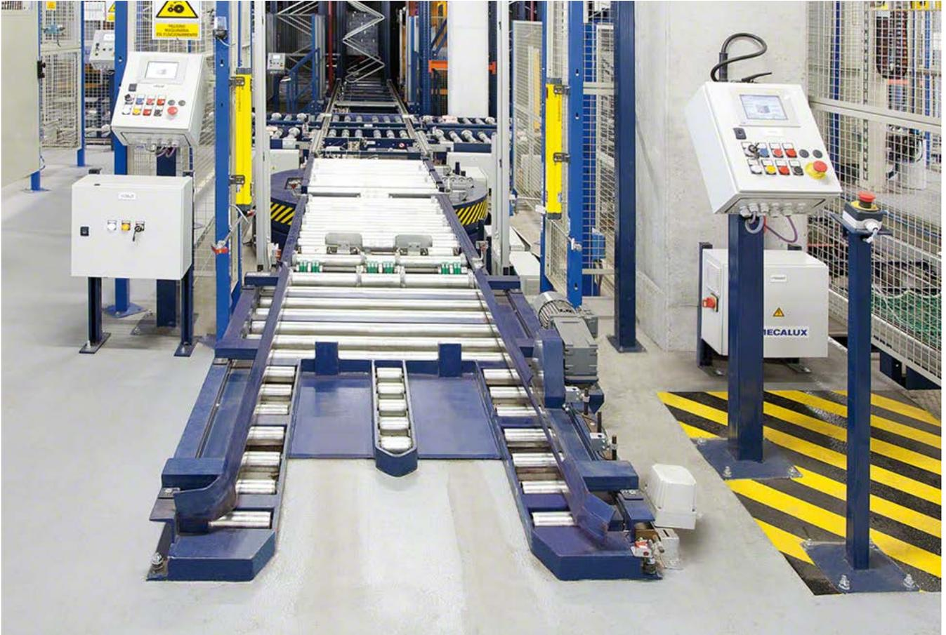
Mit diesem Fördererelement werden Ladeeinheiten mithilfe eines Palettenhubwagens auf Bodenebene in den Kreislauf eingebracht oder von dort entnommen, sodass keine Gabelstapler notwendig sind. Es verfügt über kein Hubsystem, weshalb es mit einem Hydrauliktisch verbunden oder der Förderer sich auf Bodenebene befinden muss.
