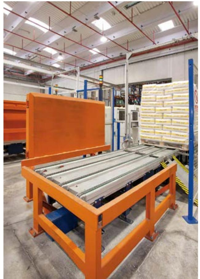
Diese Schutzelemente aus Metall werden an Eingangs- und Ausgangsförderern angebracht, um zu verhindern, dass sie beim Platzieren oder Entnehmen der Paletten mit einem Gabelstapler beschädigt werden. Der Schutz des Eingangsförderers besteht aus Palettenzentrierstücken, die die korrekte Platzierung der Ladeinheit auf dem Förderer erleichtern.
