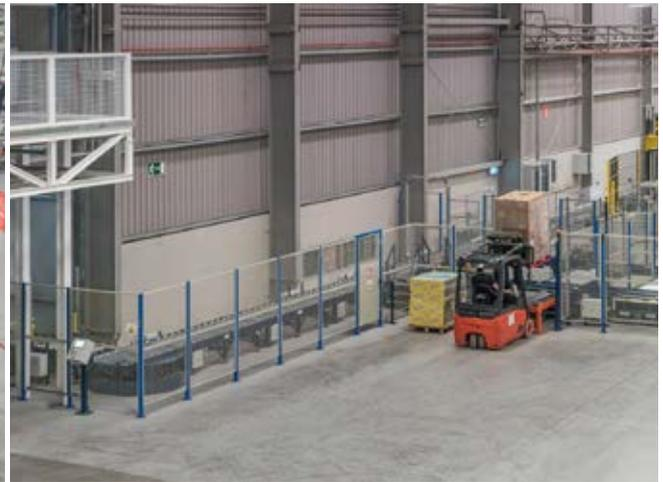
In diesem Fall **verbinden die Fördervorrichtungen verschiedene Produktionsbereiche miteinander** und diese wiederum mit dem Lager. Die Fördervorrichtungen verfügen über direkte Verbindungen zu den Vorbereitungsgeräten für Paletten, zu den Bereichen für Überprüfung und Qualitätskontrolle sowie mithilfe von Gabelstaplern zu den Eingängen.
