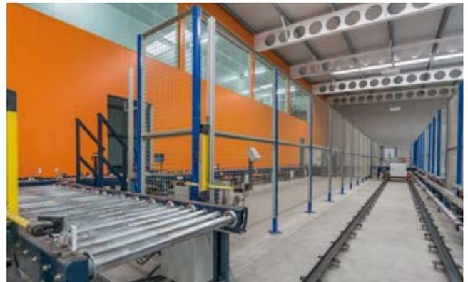
**Einfache Shuttles.** Sie können als Hauptförderer in einem Kreislauf mit verschiedenen Ausgangspunkten und einem einzigen Zielpunkt dienen, wobei sie die verschiedenen Punkte miteinander verbinden. Dies ist eine gute Option, wenn der Bewegungsfluss nicht sehr hoch ist und große Entfernungen bei minimalen Kosten überbrückt werden sollen.
