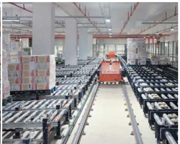
Hier ist ein **Kreislauf dargestellt, der verschiedene Bereiche innerhalb eines Lagers miteinander verbindet**, einschließlich geschlossener Behandlungsbereiche. Auch hier werden Shuttles als Elemente für Klassifizierung und Warenempfang eingesetzt.
