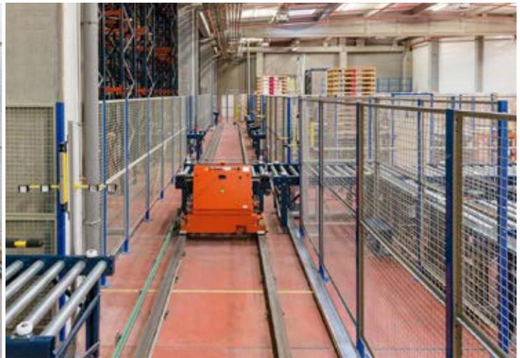
In diesem Beispiel werden die aus der Produktion stammenden Paletten zu den Ausgangskanälen transportiert, wobei **das Shuttle dazu dient, die verschiedenen Ausgangskanäle mit den Zielkanälen zu verbinden.**
