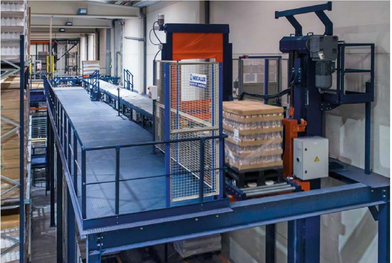
Automatisiertes Transportsystem für die vertikale Beförderung von palettierter Ladung von bis zu 1500 kg. Durch die Auf- bzw. Abwärtsbewegung können die Paletten fortlaufend und rasch zwischen verschiedenen Stockwerken oder Ebenen der Anlage bewegt werden.
