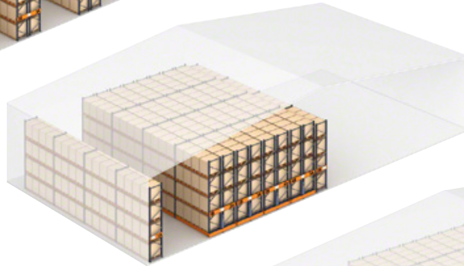
Kompaktlager mit verschiebbaren Verfahrwagen. Bei gleicher Kapazität und mit nur einem Gang wird weniger Raum benötigt
