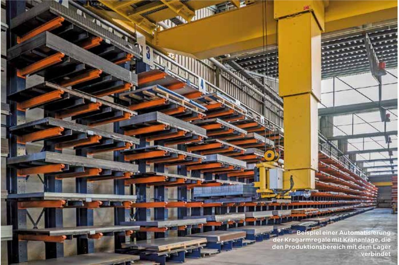
Beispiel einer Automatisierung der Kragarmregale mit Krananlage, die den Produktionsbereich mit dem Lager verbindet
