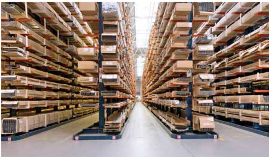
Sie bestehen im Wesentlichen aus vertikalen Profilen (Ständern) und horizontalen Profilen (Füßen), die gemeinsam das Grundgerüst bilden und so Stabilität schaffen, sowie Arme, auf denen die Last platziert wird.
