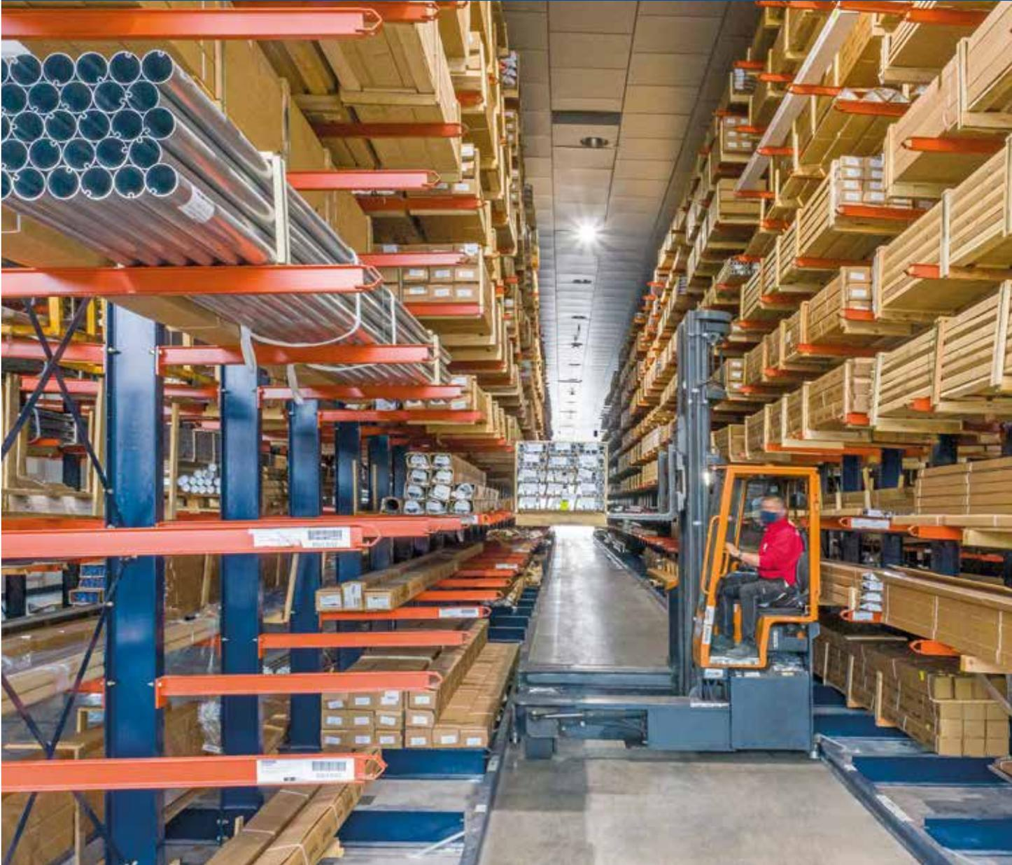
Mecalux hat unterschiedliche warmgewalzte Profile entwickelt, die das Kragarmregalsystem bilden und mit entsprechenden Abmessungen und Gewichten allen Marktanforderungen gerecht werden. Abgesehen vom Gewicht der Lasten müssen bei der Auswahl des passenden Systems zudem die Abmessungen der einzulagernden Waren sowie die
