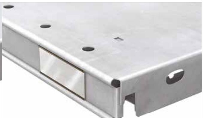
Die Falzungen der HM-Fachböden auf der Vorder- und Rückseite bilden ein geschlossenes und geklammertes Rohrprofil mit großer Tragfähigkeit. Diese Fachböden gibt es in der gelochten Variante zur Anbringung vertikaler Fachtrenner oder Zubehör.
