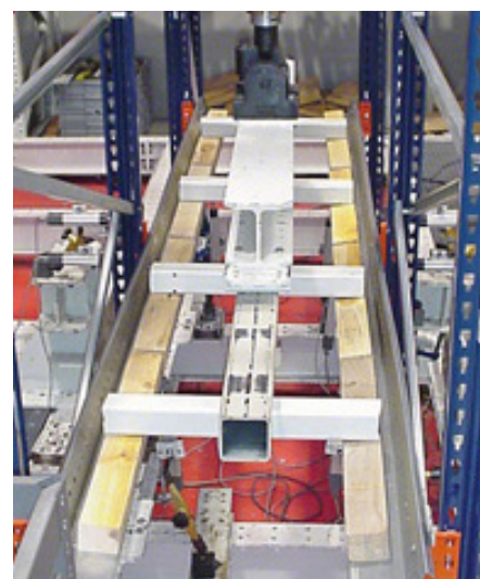
Abb. 4. Beispiel für die Prüfung einer Auflageschiene
