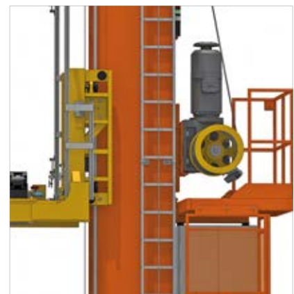
Handleiter und Plattform oben für Instandhaltungsarbeiten
