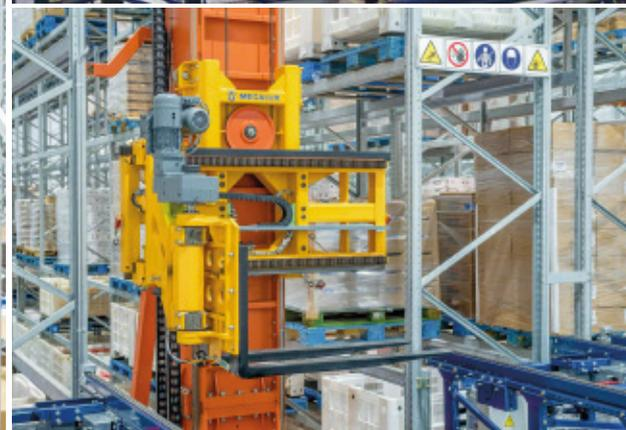
Das auf Schienen geführte Regalbediengerät hat nur vier Auflagepunkte. Es hat keine obere Führungsschiene, so dass es in jedem Lager, in dem normalerweise Gabelstapler eingesetzt werden, leicht zu installieren ist. Darüber hinaus eignet es sich für fast alle Bereiche mit direktem Palettenzugang.
