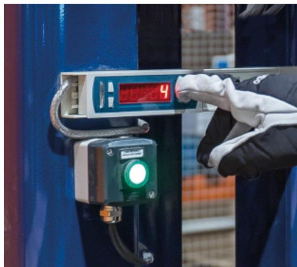
Die *Put-to-Light*-Vorrichtung zeigt die Anzahl der Artikelarten an, die auf jeder Palette platziert werden sollen. Nach Abschluss des Vorgangs drückt der Lagerarbeiter auf die Taste, um das LVS darüber zu informieren. Dieses System sorgt für große Schnelligkeit bei den Abläufen, verringert die Anzahl der Fehler bei der Auftragszusammenstellung und ermöglicht die Aktualisierung des Bestands in Echtzeit, da sämtliche Informationen an das LVS übermittelt werden.
