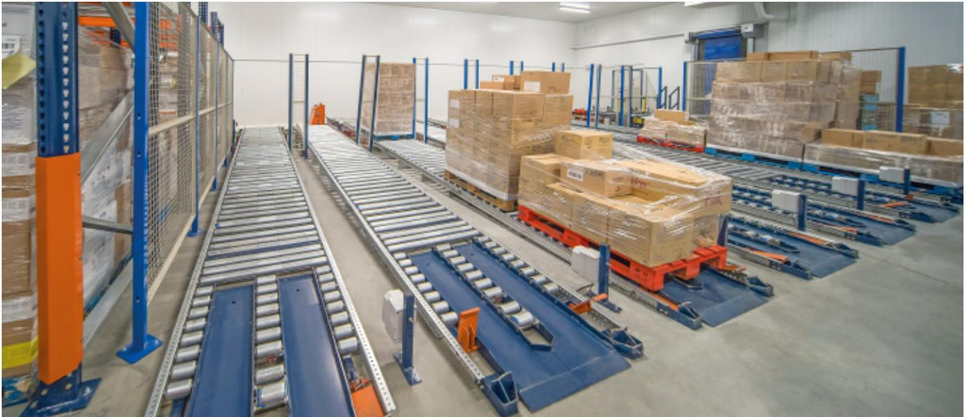
**Sicherheit der Ware.** Im Versandbereich herrscht ebenfalls eine kontrollierte Temperatur, um die Kühlkette nicht zu unterbrechen. Außerdem sorgen Rückhaltevorrückungen, Bremsrollen und andere in den schwerkraftgesteuerten Kanälen eingebaute Vorrichtungen für eine automatische Kontrolle der Geschwindigkeit sowie für das Anhalten der Paletten und verhindern so Staus und Zusammenstöße.
