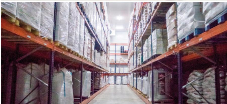
Mecalux hat drei Tiefkühlager von Frío Valencia mit Movirack-Verschieberegalanlagen ausgestattet. Das System nutzt die gesamte Fläche des Lagers aus und bietet eine Lagerkapazität von mehr als 7700 Paletten und gleichzeitig einen direkten Zugang zu den Artikeln, sobald ein Gang geöffnet wird.
