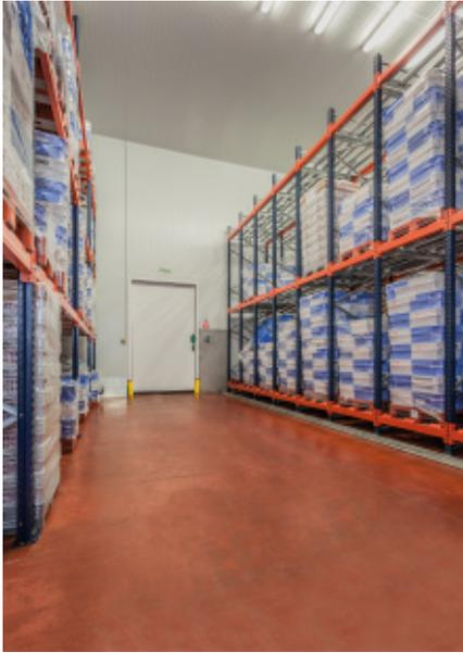
**Schwerkraftgesteuerte Durchlaufregale für Paletten: frische Halbfertigprodukte**
