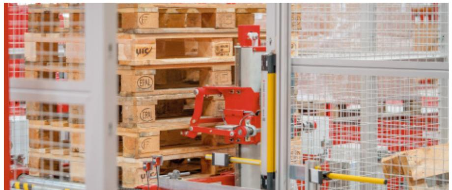
Das System stellt leere Paletten bereit, die als Hilfspaletten für solche Paletten verwendet werden, die von der Kontrollstation als fehlerhaft erkannt werden.
