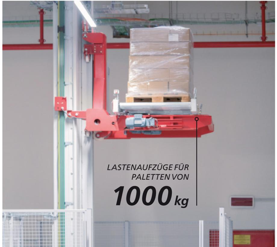
Zur Anlage gehören **zwei Lastenaufzüge**. Einer hebt die Paletten vom Eingangsbereich auf die obere Ebene (Eingänge) und transportiert sie von der oberen Ebene hinunter in
