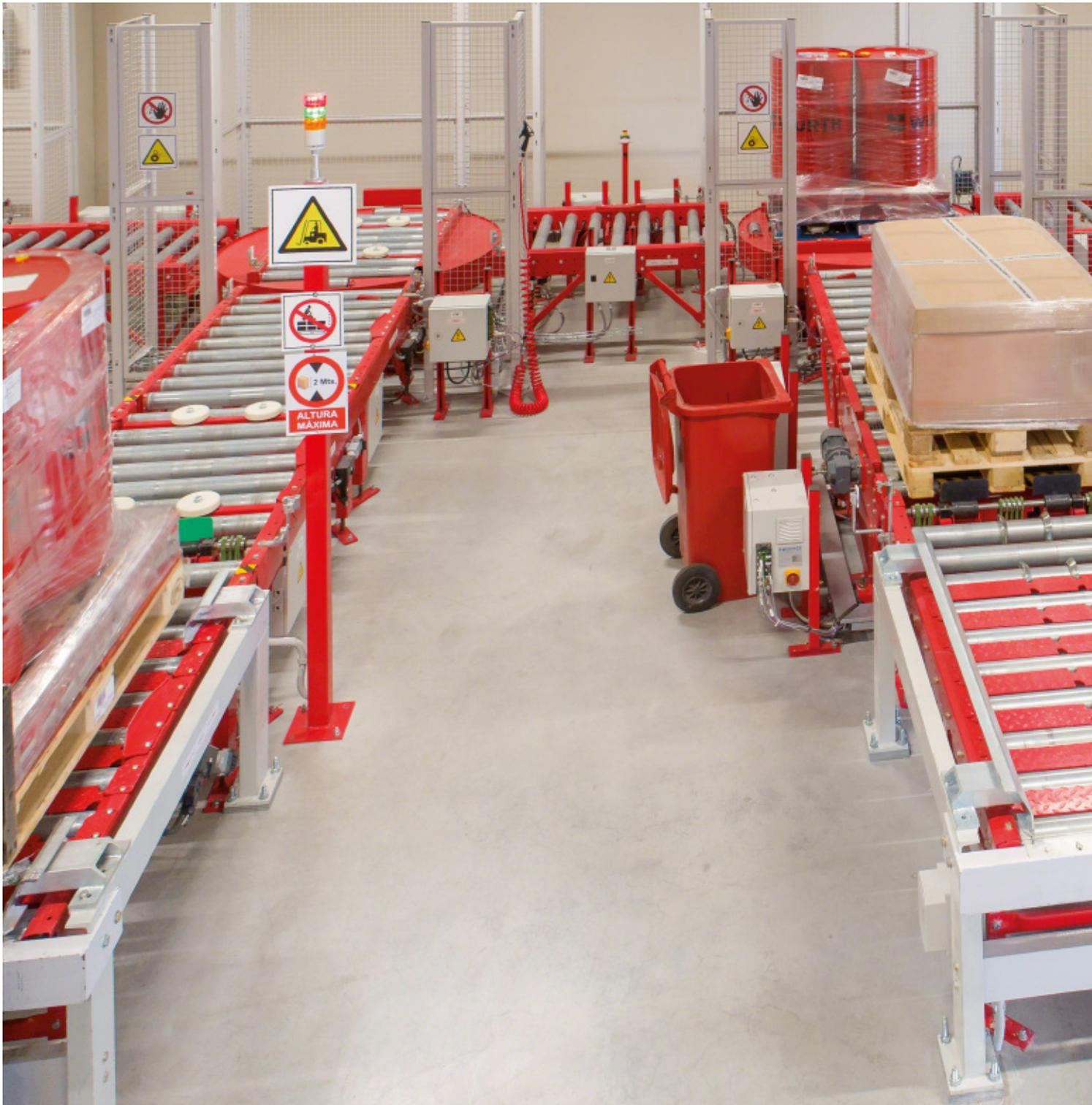
Lastenaufzug transportiert ebenfalls die aus dem automatisierten Lager kommenden Paletten in den Versandbereich. Am Ende der Ausgangslinie werden die Trägerpaletten entnommen und gestapelt, sodass sie wieder für Einlagerungen verwendet werden können. Die für den Versand bestimmten Paletten werden im Bereich zur Ladevorbereitung auf dem Boden direkt vor den Laderampen in Gruppen angeordnet, die einer gleichen Bestellung oder Transportroute entsprechen.
