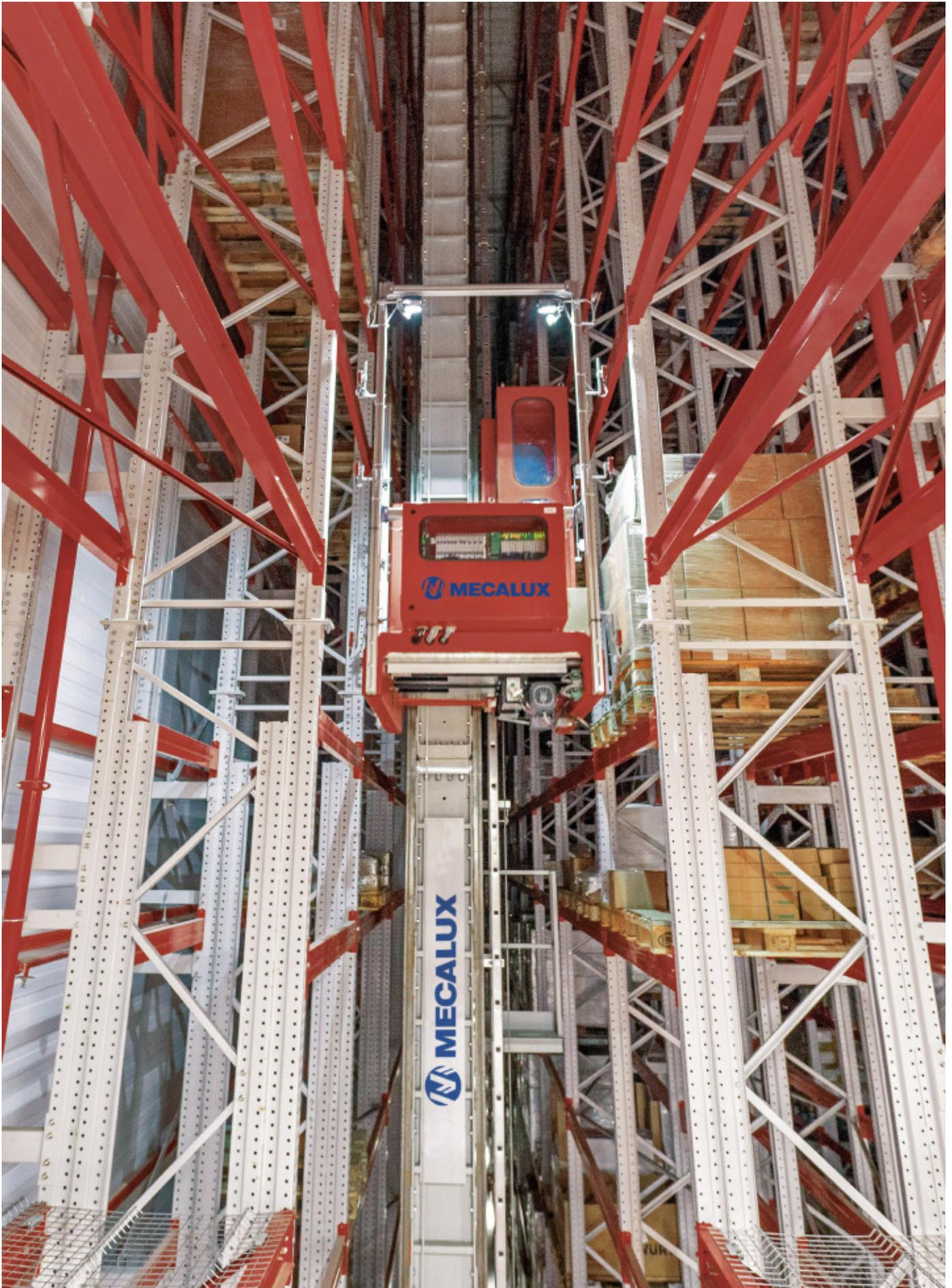
Einmast-Regalbediengerät einfacher Tiefe mit einer Verfahrgeschwindigkeit von 220 m/min und einer Hubgeschwindigkeit von 54 m/min.
