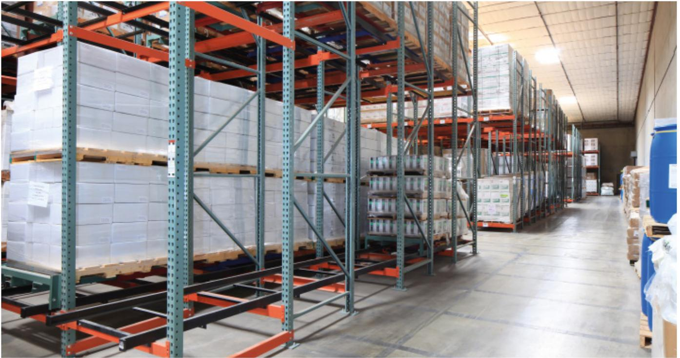
Die gesamte Regalanlage wurde so konzipiert, dass sie ein breites Sortiment von GMA-Paletten mit einem Gewicht zwischen etwa 500 und 1000 kg aufnehmen kann
