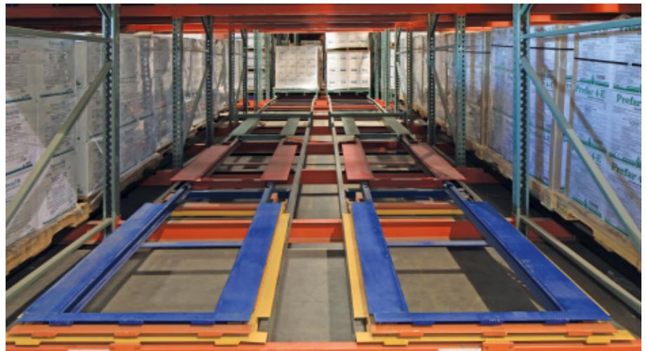
Back-Systems die Schwerkraft ausnutzen, um die hinteren Paletten in der Regalanlage nach vorne umzusetzen, sind keine anderen Lösungen, wie Kompaktregale oder Gabelstapler mit Teleskopgabeln, notwendig.
