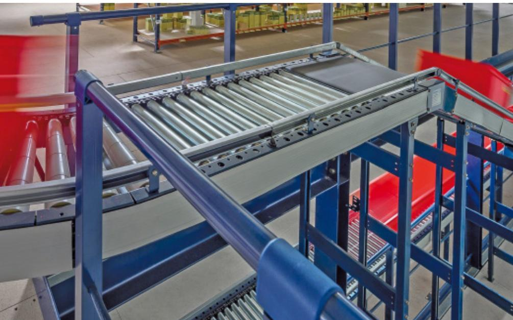
Die Förderbänder können Höhenunterschiede überwinden und ermöglichen den Zugang zu den verschiedenen Ebenen des Lagers von PAVI-Groupauto, während die klappbaren Fördermodule den Durchgang der Lagerarbeiter erleichtern
