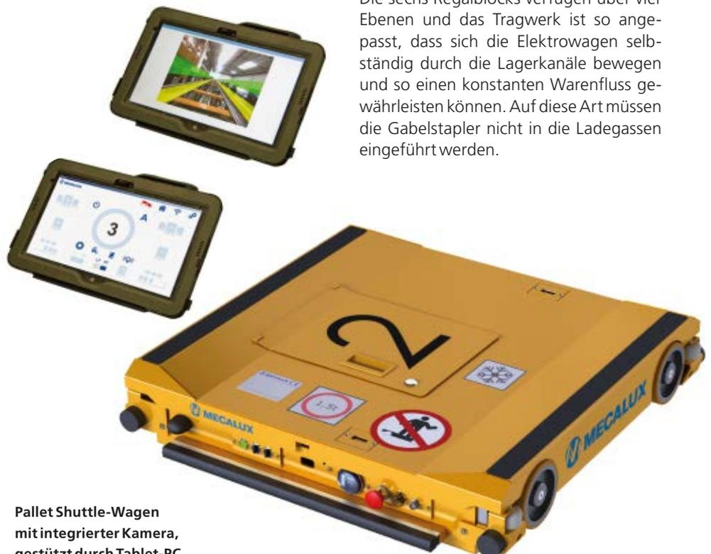
Pallet Shuttle-Wagen mit integrierter Kamera, gestützt durch Tablet-PC
