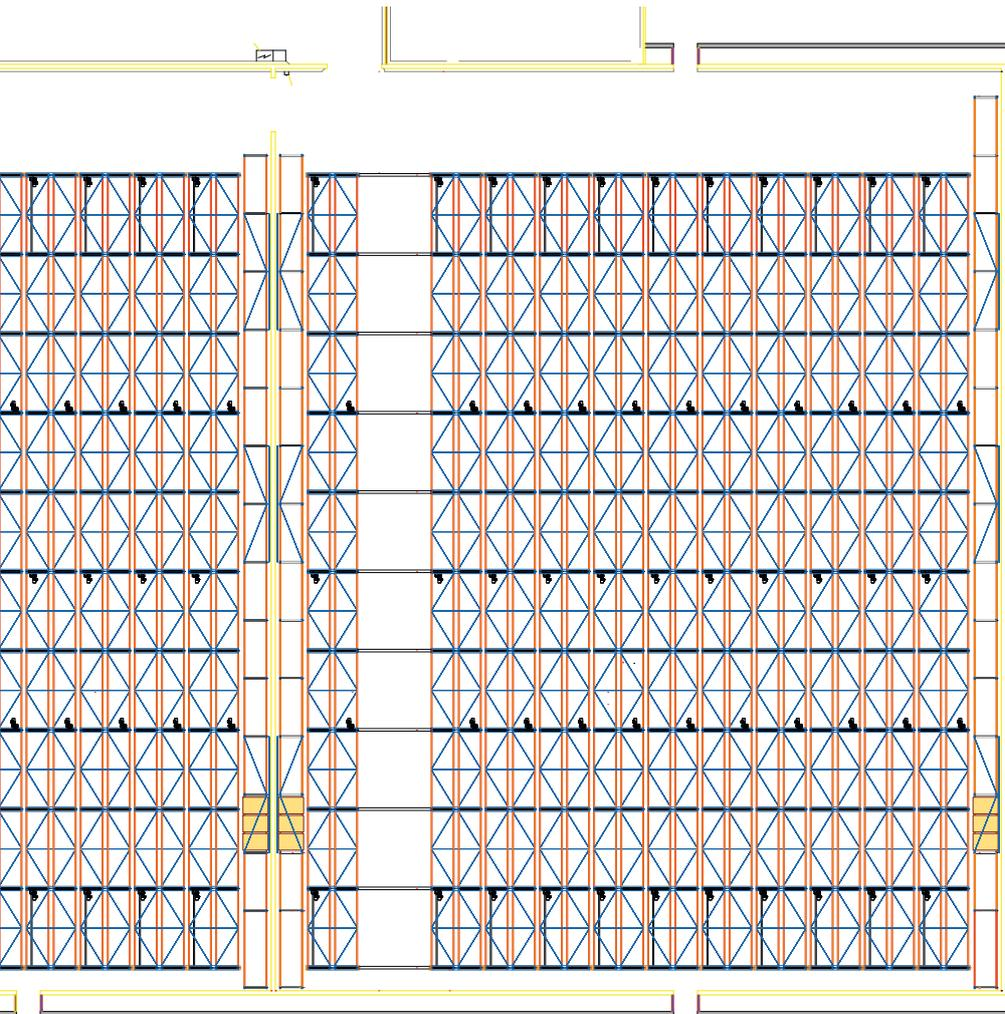
Das Movirack-System ist ideal, um den verfügbaren Raum maximal auszunutzen und die Gesamt-Lagerkapazität zu erhöhen, ohne auf den direkten Zugang zu jeder Palette zu verzichten
