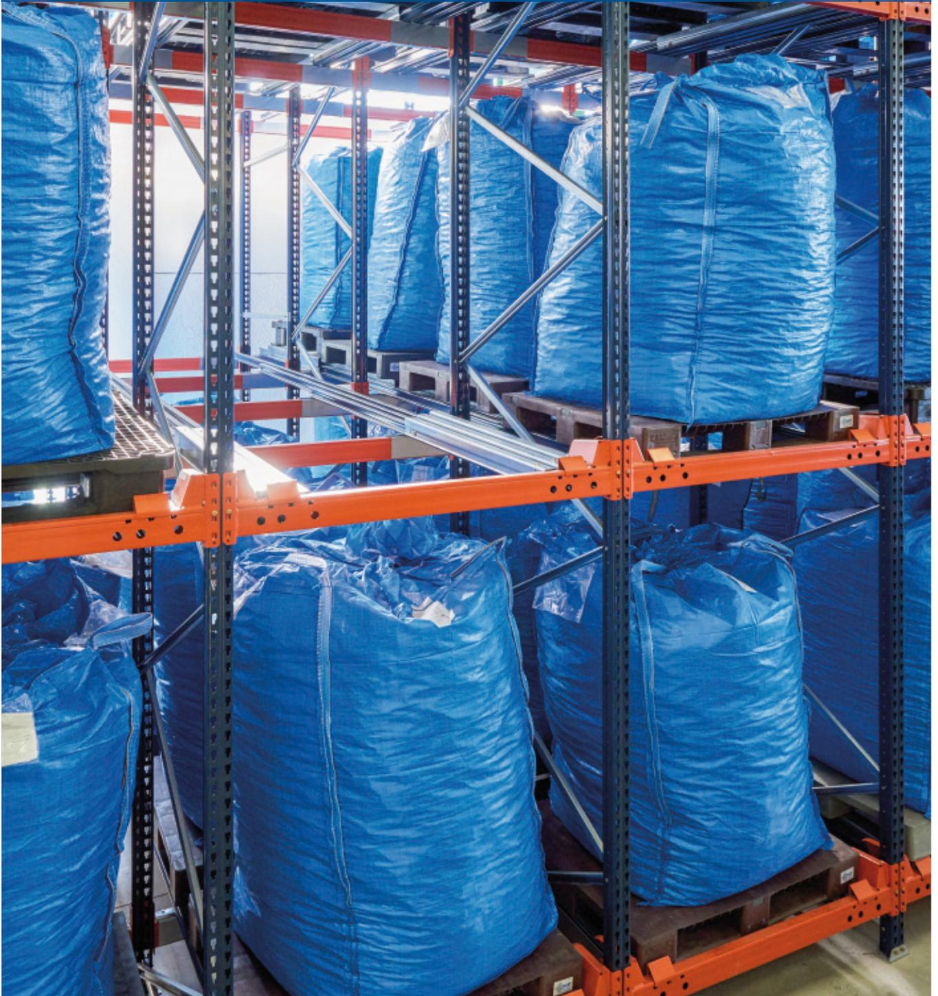
Der Naturkorkenhersteller Belbo Sugheri hat in seinem Lager in Calamandrana (Italien) eine Push-Back-Palettenregalanlage von Mecalux installiert. Diese Regalanlage, die Platz für 264 Paletten bietet, hat die Zahl der gelagerten Paletten vervielfacht und die Be- und Entladung beschleunigt.
