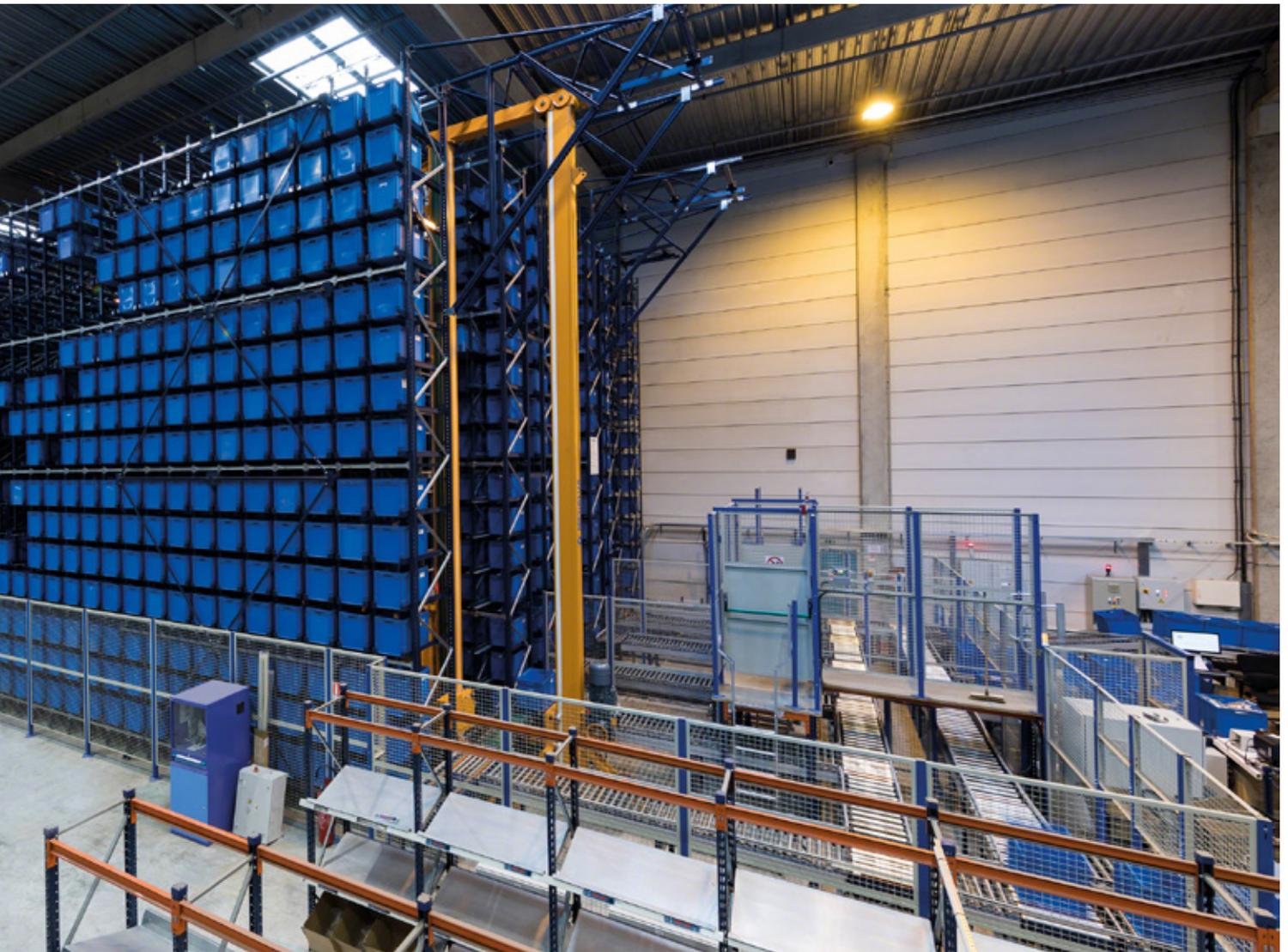
mast-Miniload-Regalbediengerät, das für die Ein- und Auslagerung der Ware verantwortlich ist. Diese Geräte arbeiten mit einer Seitwärtsgeschwindigkeit von 250 m/min. und einer Hubgeschwindigkeit von 90 m/min.
