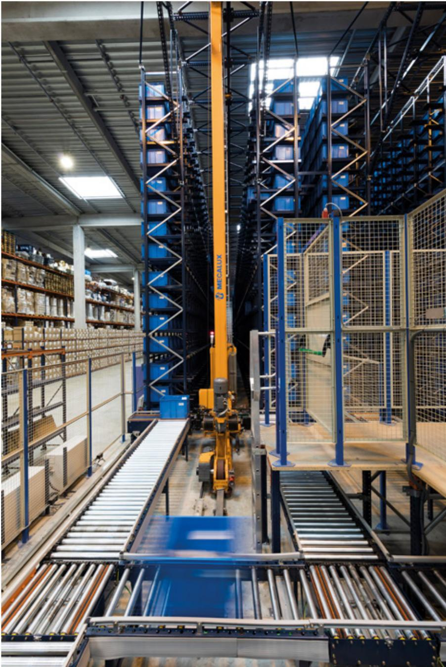
An der Vorderseite des automatischen Lagers befinden sich drei Kommissionierstellen, an denen die Aufträge gemäß dem Prinzip „Ware zur Person“ zusammengestellt werden, d. h., die Regalbediengeräte bringen die Ware direkt zu den Kommissionierern. Dazu setzen sie die Behälter auf die Fördervorrichtungen, die sie automatisch zu den Kommissionierstellen bringen.
