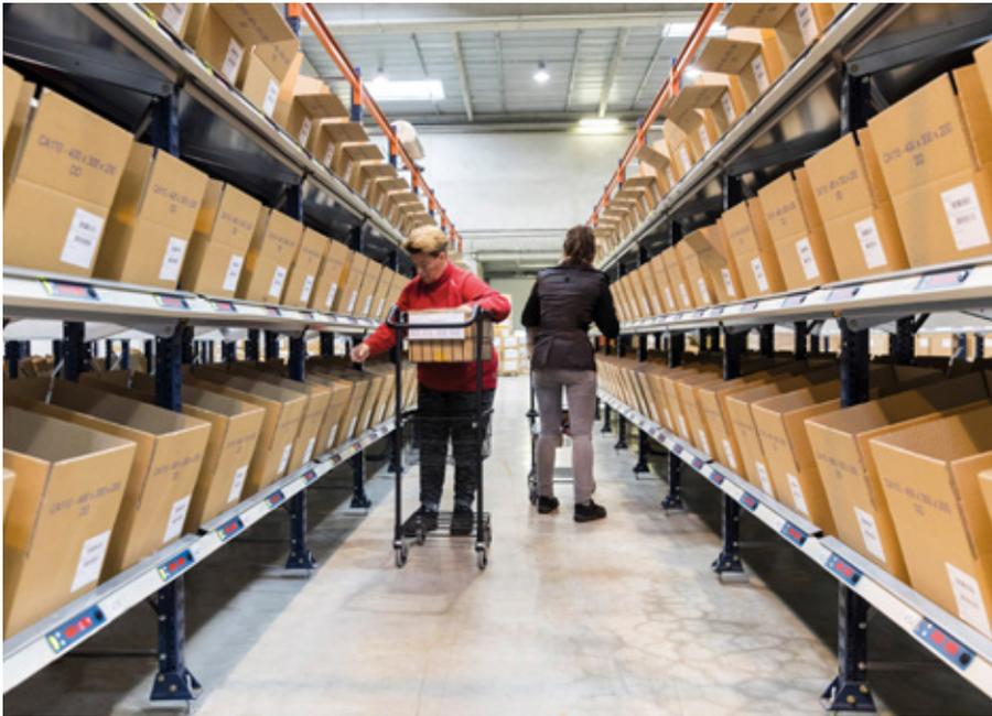
In den Regalen ist jede Lagerposition mit einer Leuchtanzeige versehen, die die Anzahl der erforderlichen Artikel anzeigt. Die Kommissionierer laufen durch die Gänge, während sie die Produkte in die Kisten legen, die die *Put-to-Light*-Vorrichtungen anzeigen. Anschließend drücken sie auf die Anzeige, um zu bestätigen, dass der Vorgang durchgeführt wurde.
