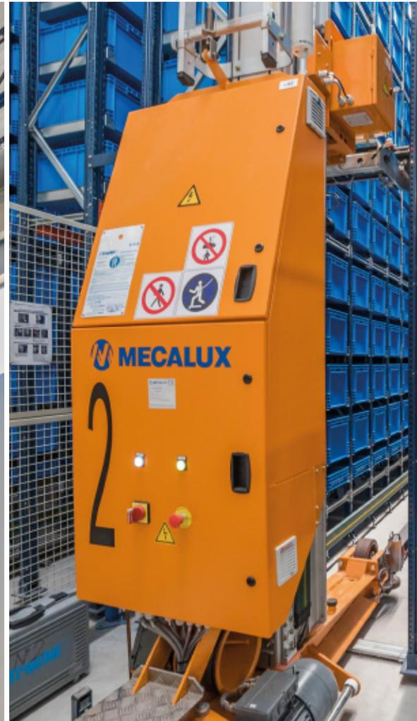
Das automatische Lager besteht aus drei Gängen mit Regalanlagen einfacher Tiefe auf beiden Seiten. Die Regalanlage verfügen über 19 Ebenen mit einer Höhe von 8,6m.
