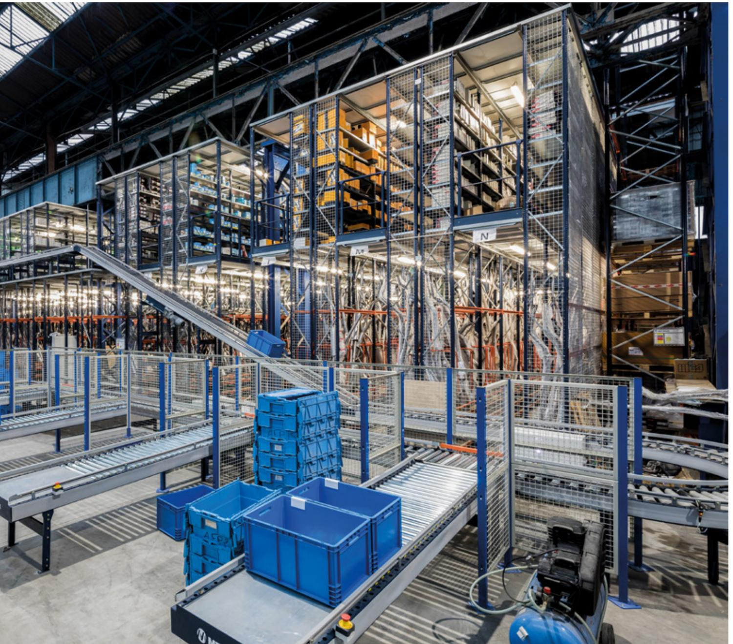
Die Regale mit Laufgängen nutzen die gesamte Höhe des Logistikzentrums, um den verfügbaren Raum zu maximieren und eine größere Lagerkapazität zu erreichen
