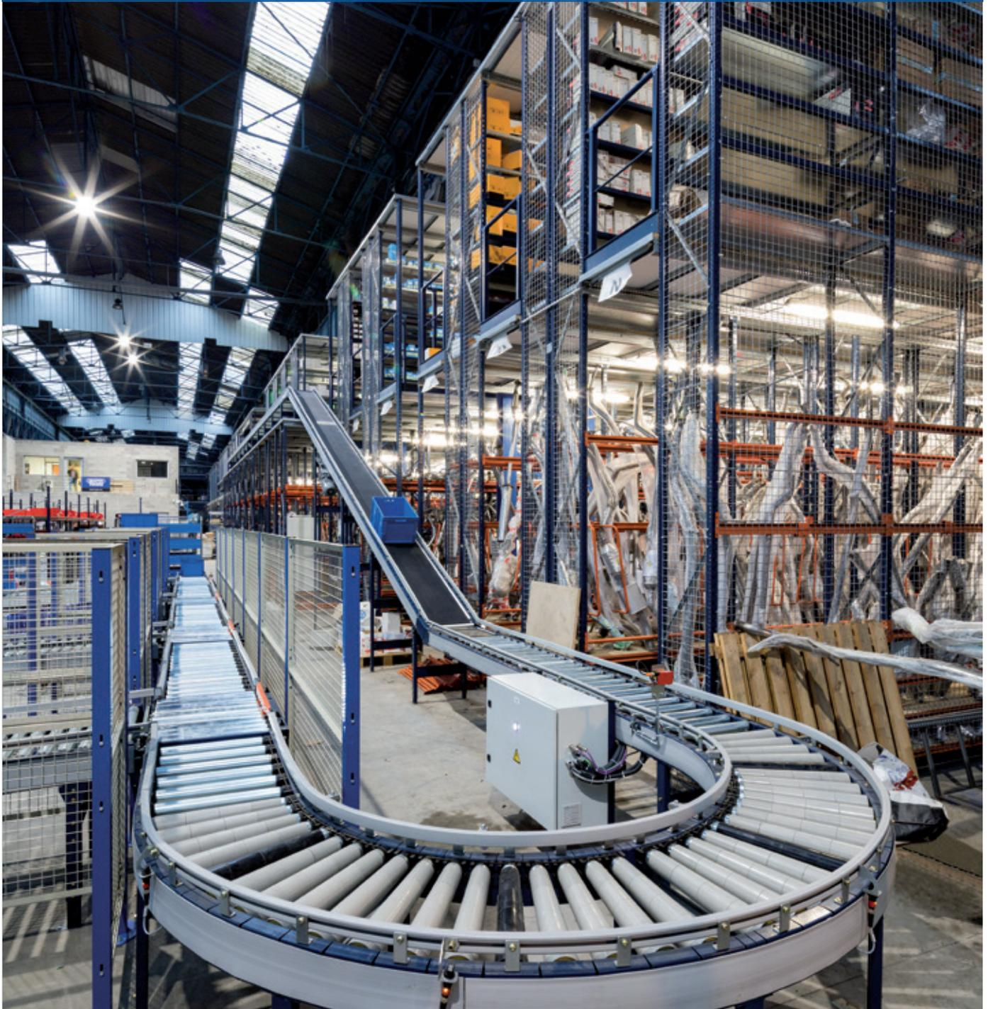
Automotive Factory Parts, ein Vertriebshändler für Autoersatzteile, besitzt ein modernes, 5000 m<sup>2</sup> großes Logistikzentrum in Gennevilliers (Frankreich), das hauptsächlich zur Abwicklung von Onlinebestellungen dient. Mecalux hat die Lagersysteme geliefert, zu denen auch ein Förderkreislauf gehört, der alle Bereiche der Einrichtung miteinander verbindet, um die Kommissionierung zu beschleunigen.
