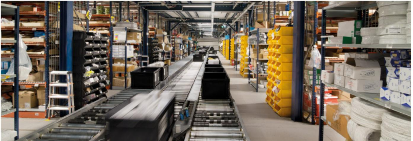
Die Regalebenen bestehen aus gelochten Regalböden, die hohe Lasten tragen können und außerdem das Durchlaufen von Wasser ermöglichen, falls das Brandschutzsystem ausgelöst wird. An den Enden der Regale wurden Seitenwände aus senkrechten Gittern angebracht.
