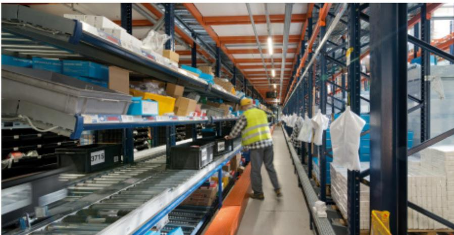
Der Kommissionierblock besteht aus Durchlaufregalen für Paletten und Behälter, Regalzeilen mit Fachböden und einem Förderkreislauf, der auf jeder Ebene zwei Bereiche für die Auftragszusammenstellung bildet
