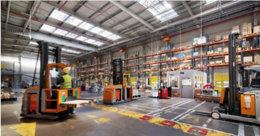
Die Kommissionierung auf der unteren Ebene der Regalanlage führen die Lagerarbeiter mit Kommissionierstaplern durch, sowohl mit Niederhub- als auch mit Hochhubkommissionierern.
