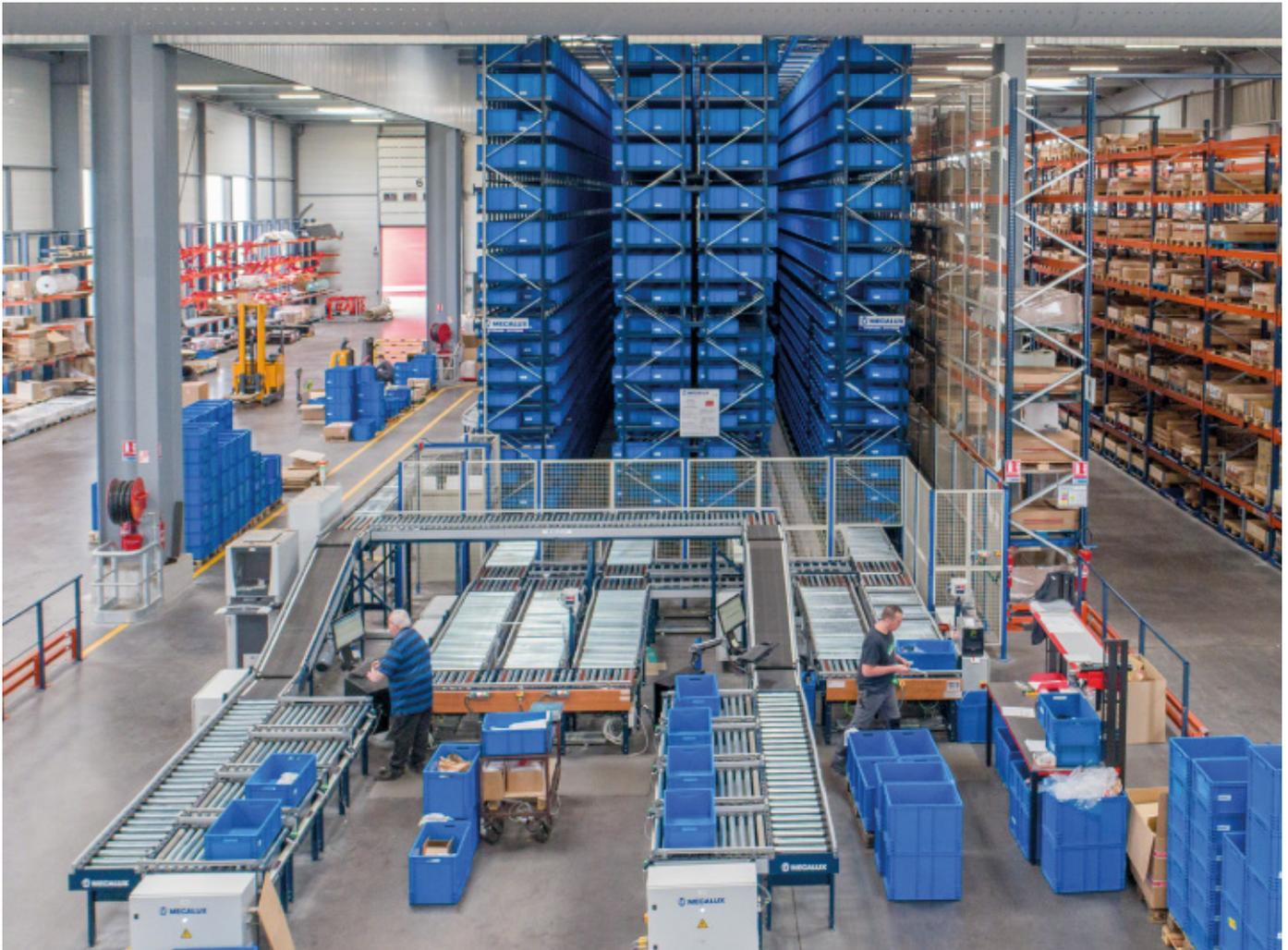
Das Lager besteht aus zwei 47 m langen und 9 m hohen Gängen mit herkömmlichen Palettenregalanlagen doppelter Tiefe auf beiden Seiten, die über 17 Ebenen verfügen.
