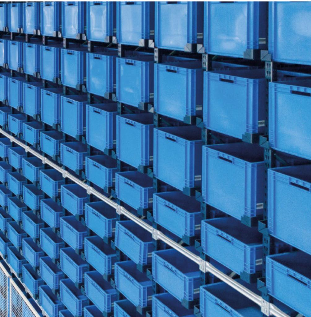
Die Regalanlagen verfügen über eine Lagerkapazität von 5920 Behältern von 600 x 400 x 240 mm und 4144 Behältern von 600 x 400 x 420 mm, was insgesamt 10.064 Behälter mit kleineren Produkten ergibt
