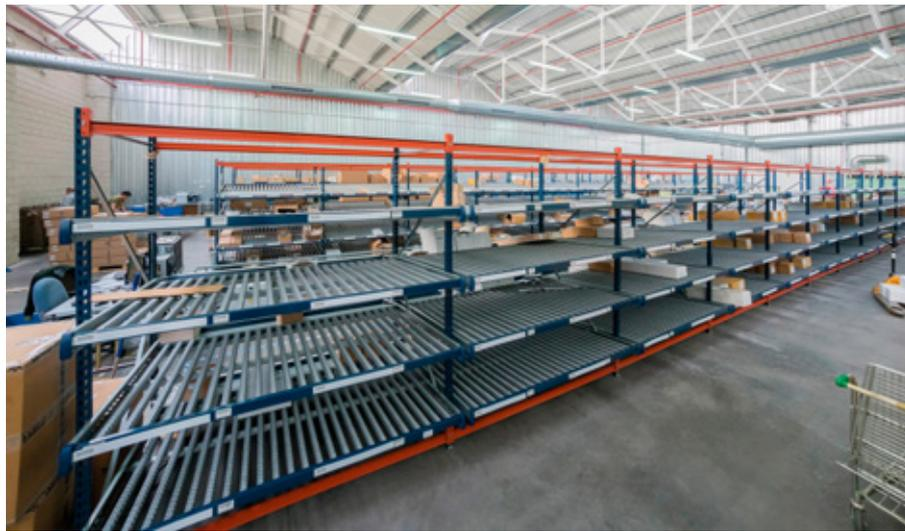
zusammenzustellenden Aufträge abhängt. Mit einem Handterminal identifizieren die Kommissionierer den Auftrag, den sie bearbeiten werden, und ein Computer zeigt ihnen die Produkte an, die sie benötigen. Nachdem ein Teil der Bestellung an einer der Stationen abgeschlossen ist, werden die Kisten auf den Hauptförderer gesetzt, der sie automatisch zur nächsten Station transportiert, wo andere Produkte, die zur Bestellung gehören, hinzugefügt werden.
