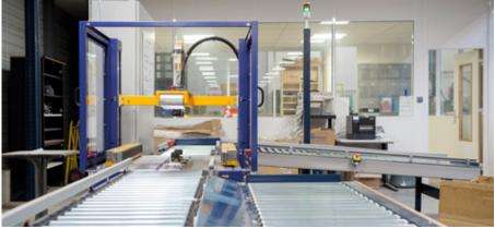
Parallel dazu befindet sich ein Rollenförderer mit nicht motorisierten Rollen, mit dem die Lagerarbeiter die Behälter von Hand in die geeignete Position bewegen können.
