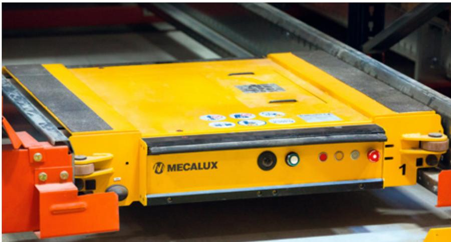
Die Lagerprozesse werden mit Tablet-PCs gesteuert, mit denen die Befehle an die Pallet-Shuttle-Wagen gesendet werden. Sie verfügen über eine berührungsempfindliche Schnittstelle und eine sehr intuitive Software, deren Anwendung keine spezielle Schulung erfordert. Jeder Tablet-PC kann mit allen Wagen des Lagers interagieren, wobei ein Prioritätsprotokoll befolgt wird.
