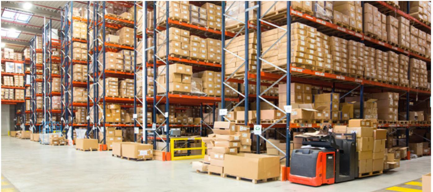
Aufgrund der großen Vielfalt an Paletten wurde die Höhe der Regalebene an die Art der gelagerten Ware und an die Abläufe angepasst. Auf der unteren Ebene der Regalanlage erfolgt die Kommissionierung direkt von den Paletten, während die Reserve auf
