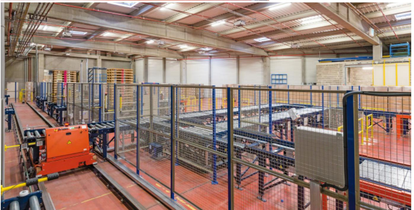
Der Förderkreislauf enthält ebenfalls einen Palettenunterleger, mit dessen Hilfe die Paletten auf Trägerpaletten gesetzt werden können, und ein Gerät zum Auf- und Entstackeln leerer Paletten.
