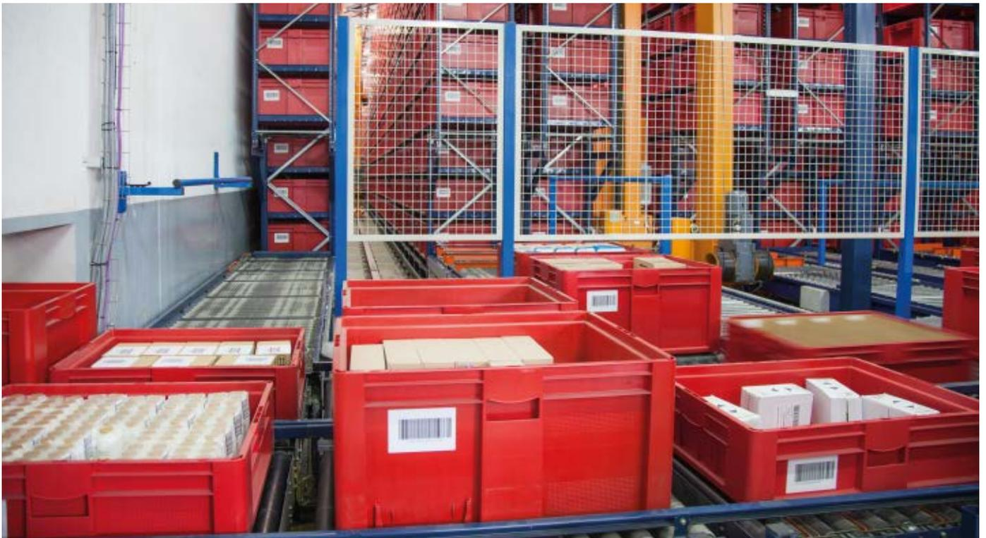
Die beiden letzten installierten Gänge mit einer Kapazität für 5.204 Behälter besitzen drei Ladeebenen mehr. In jedem Gang bewegt sich ein Zweimast-Regalbediengerät für Behälter von 800 x 600 mm mit doppelten Gabelzinken im Schlitten, das jeweils über 40 kombinierte Zyklen pro Stunde durchführen kann, was für alle Regalbediengeräte insgesamt 280 Zyklen ergibt. Es können also stündlich 560 Behälter eingelagert und 560 Behälter entnommen werden.
