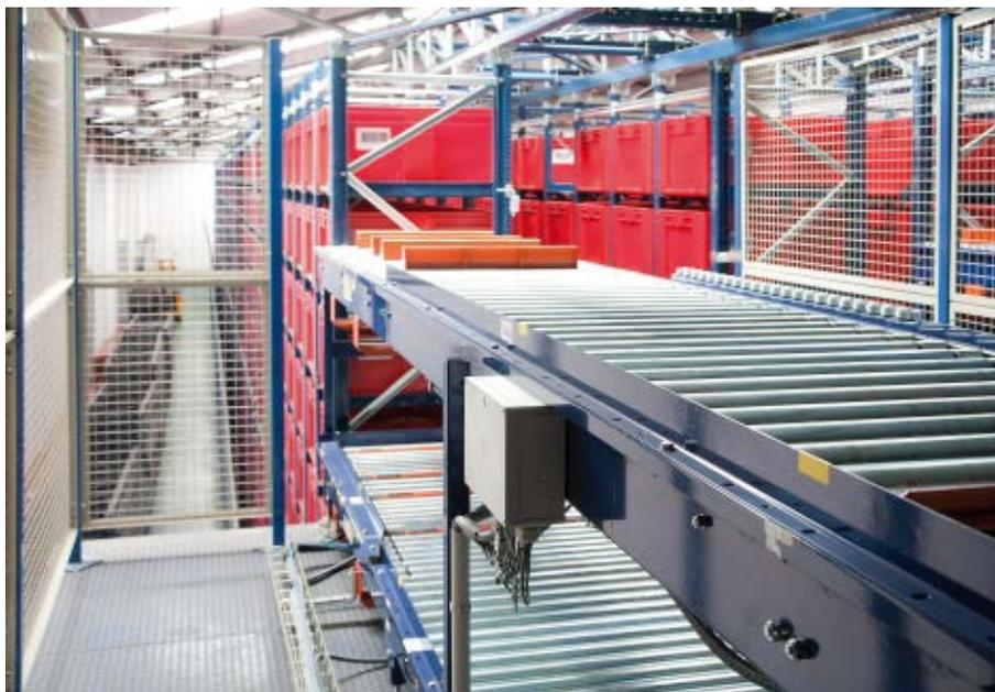
Mecalux hat ein automatisches Miniload-Lager mit Kapazität für über 14.200 Behälter und einen Regaleingang mit zwei Ebenen geliefert: der untere Teil für die Kommissionierung und der obere Teil für das Auffüllen
