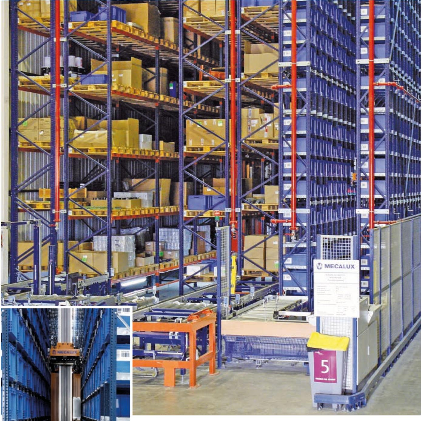
Mecalux hat als gewohnter Zulieferer von Renfe ein Lager entworfen, das für alle Wartungszentren des Eisenbahnunternehmens geeignet ist. Die Lösung besteht aus der Kombination eines Miniload-Lagers für Kisten, eines automatischen Lagers für Paletten und eines Lagers mit Kragarmregalen für sperrige Teile. Alles wird von der Lagerverwaltungssoftware Easy WMS von Mecalux gesteuert.
