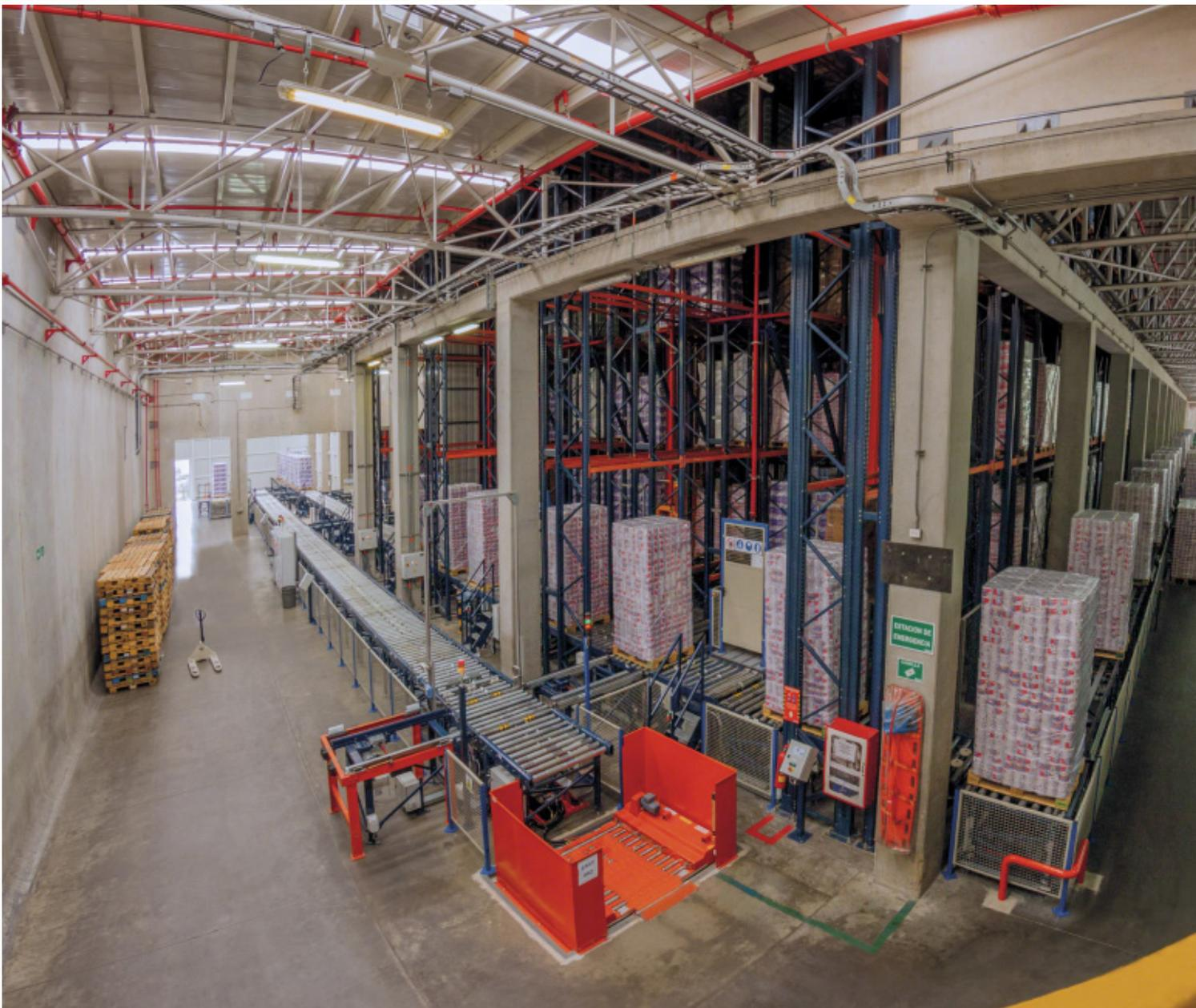
Der Förderkreislauf mit Rückführung (doppelter Kreislauf) ermöglicht die Handhabung der aus der Produktion und von auswärts kommenden Ware sowie den direkten Versand palettiertes Ware aus dem Lager
