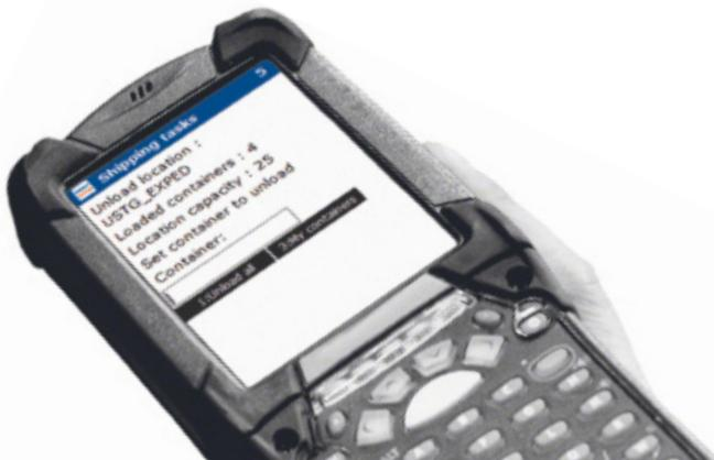
Easy WMS von Mecalux kommuniziert über Funkterminals mit den Kommissionierern und gibt ihnen die Mengen vor, die sie in den einzelnen Behältern platzieren müssen
