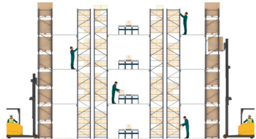
Dieses System der Zusammenstellung der Aufträge, „Ware zur Person“, vermeidet den Zeitverlust durch die Laufstrecken und verbessert sowohl die Produktivität als auch die Qualität der Kommissionierung
