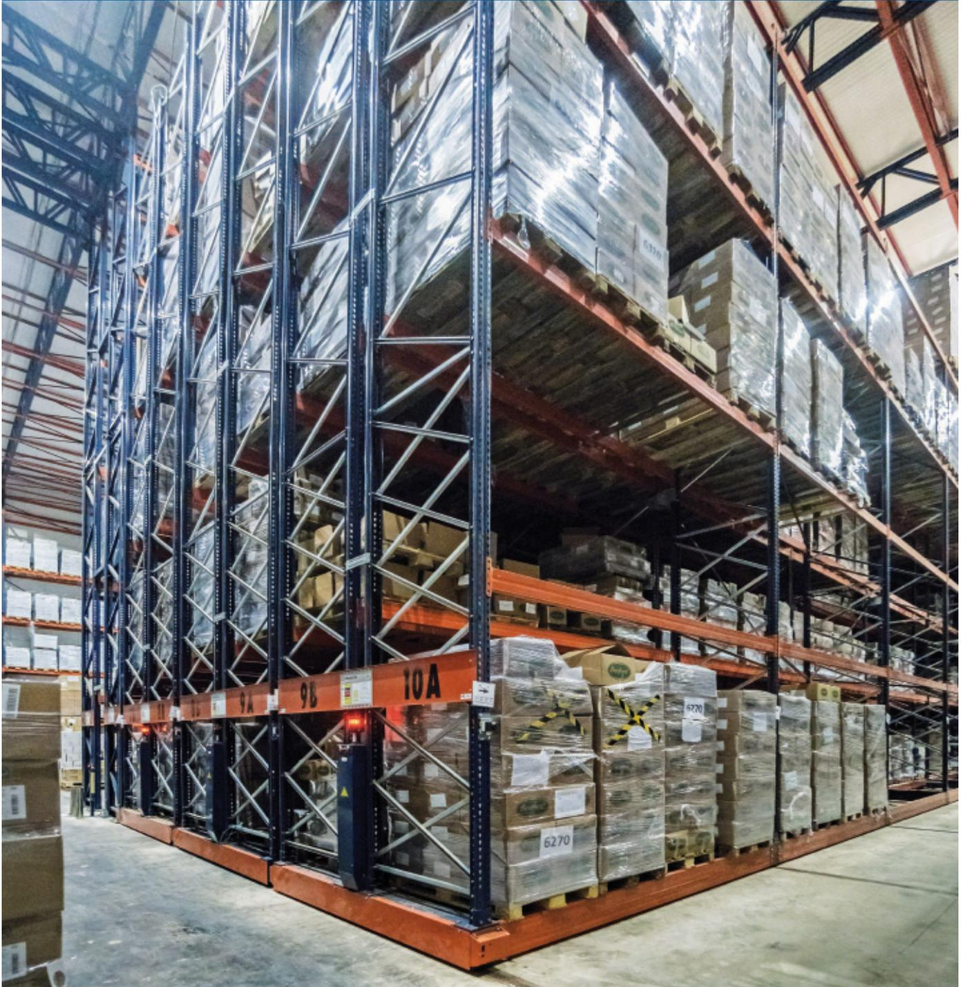
Mecalux hat für den Lebensmittelhersteller Benfood ein Hochregallager in Silobauweise errichtet und mit Movirack-Verschieberegalen ausgestattet, in denen die in seiner Fabrik hergestellten Tiefkühlprodukte gelagert werden. Mit dieser Lösung, die in der ersten Phase für die Lagerung von 2600 Paletten ausgelegt ist, erhöht das Unternehmen die Lagerkapazität und senkt die Logistikkosten.
