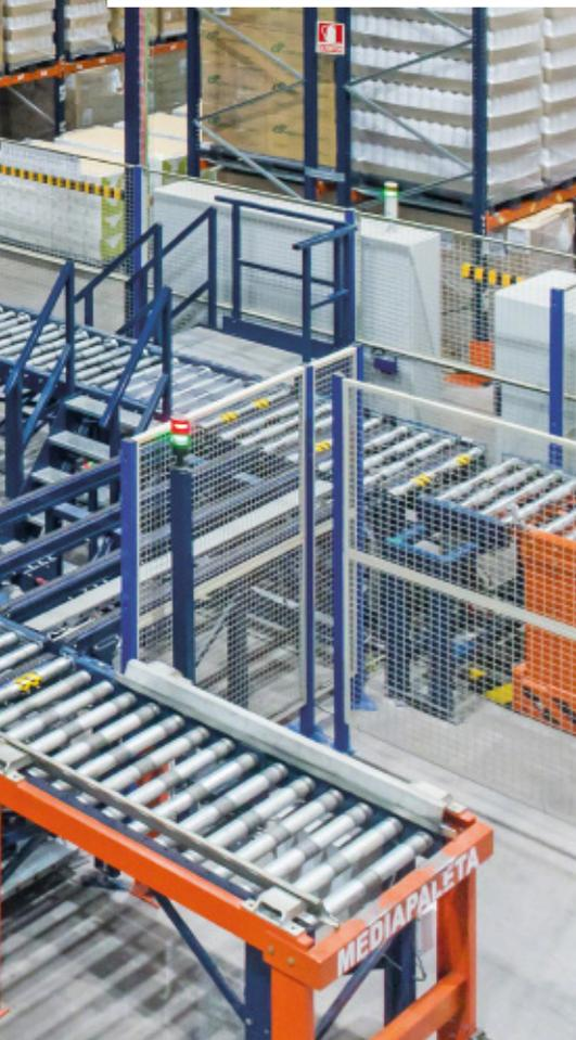
Ein leistungsstarkes Einmast-Regalbediengerät mit einem eingebauten Rollenförderer ordnet die Paletten in Durchlaufkanälen mit einer Neigung von 4 % an, was die Bewegung der Paletten durch Ausnutzung der Schwerkraft vom höchsten bis zum tiefsten Punkt erleichtert.
