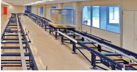
Am Anfang des Kreislaufs setzen die Lagerarbeiter die Paletten mithilfe von Gabelstaplern auf einen Hydrauliktisch, der die Last auf die Höhe des Förderers hebt. Nach Ankunft der Palette an ihrem Zielort senkt ein weiterer Hydrauliktisch sie bis auf Bodenebene ab, damit die Lagerarbeiter sie aus dem Kreislauf nehmen können.
