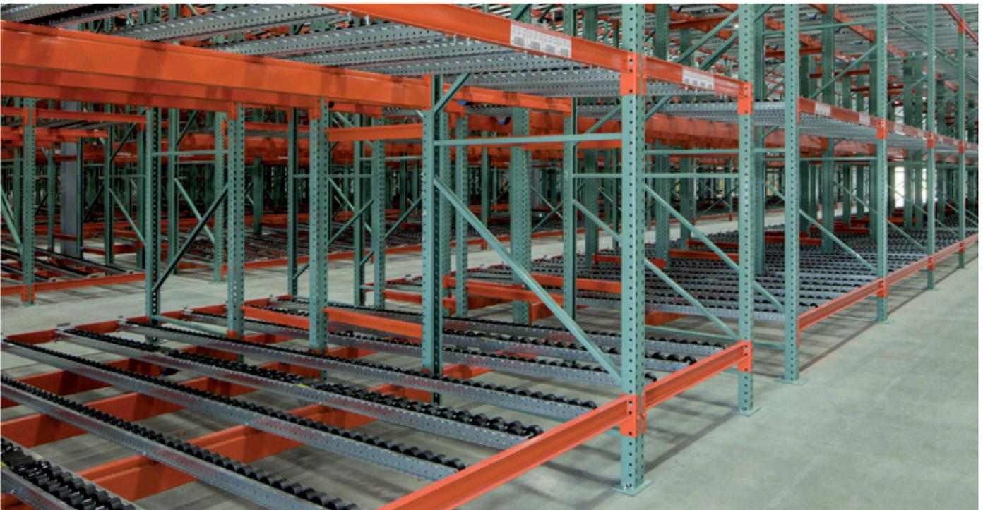
Interlake Mecalux hat das Lager von Pet Supermarket im US-amerikanischen Florida mit Durchlaufregalen ausgestattet, die eine Lagerkapazität von 2048 Paletten bieten. Der Hauptvorteil dieser Lösung besteht darin, dass sie eine perfekte Produktrotation gewährleistet und gleichzeitig die Verwaltung der 3000 Artikelarten, mit denen das Unternehmen arbeitet, beschleunigt.
