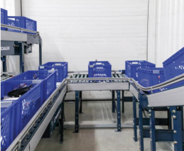
Algam, ein Unternehmen, das Musikmaterial und Audiogeräte vertreibt, hat den Bereich der Auftragskonsolidierung in seinem Lager in Thouaré-sur-Loire (Frankreich) automatisiert. Dort werden die Aufträge vor dem Versand geprüft und vorbereitet. Mecalux hat einen Förderkreislauf für Behälter installiert, der das Lager vollautomatisch mit diesem Bereich verbindet.
