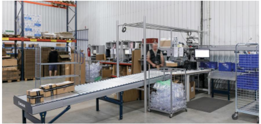
Der Förderkreislauf passt sich den Anforderungen des Standorts an und enthält gerade Strecken, Kurven sowie eine Rampe mit Bändern, um die Behälter mit kontrollierter Geschwindigkeit von der oberen auf die untere Ebene des Lagers zu transportieren
