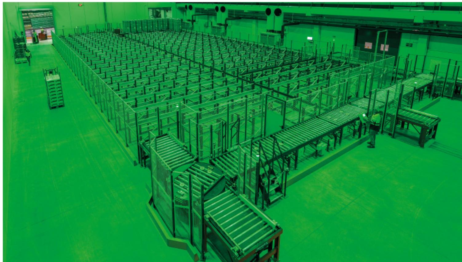
sprechen für sich: In der Anlage werden jährlich 200.000 Tonnen Kartoffeln verarbeitet, was einer Waschleistung von 70 Tonnen und einer Verpackungsleistung von 175 Tonnen pro Stunde entspricht.
