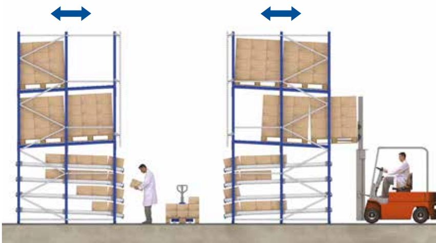
**9.** Bei dieser Lösung wird der Raum oberhalb der dynamischen Kommissionierregale zur Lagerung von Nachschub auf Rollenebenen (Einschubregal) genutzt. Die Paletten werden hierbei nur von der Beschickungsseite ein- und ausgelagert.
