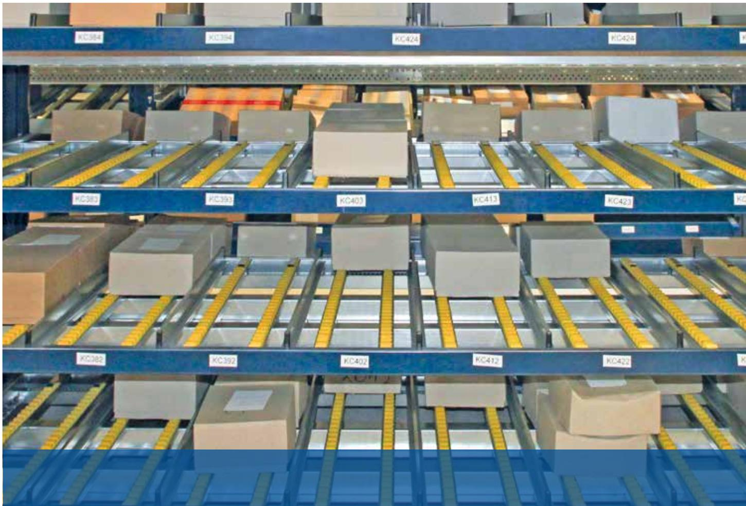
**Ein schwerkraftgesteuertes Lagersystem, das die Kommissionierzeit verkürzt und eine perfekte Rotation der gelagerten Ware ermöglicht.**
