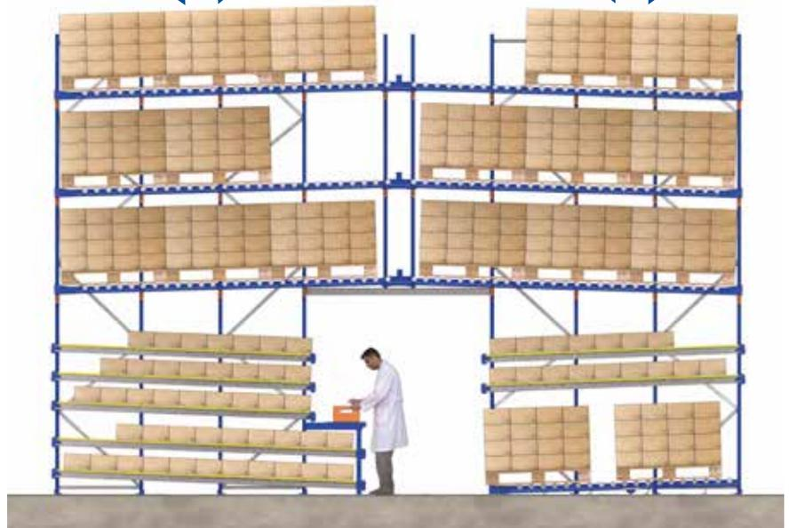
**10.** Dieser Fall ist dem zuvor gezeigten Beispiel sehr ähnlich. Der obere Bereich der Kommissioniergänge dient der Lagerung von Nachschub. Im unteren Bereich erfolgt die Kommissionierung auf einer Seite von den Stückgut-Durchlaufregalen und auf der anderen Seite von der Palette.
