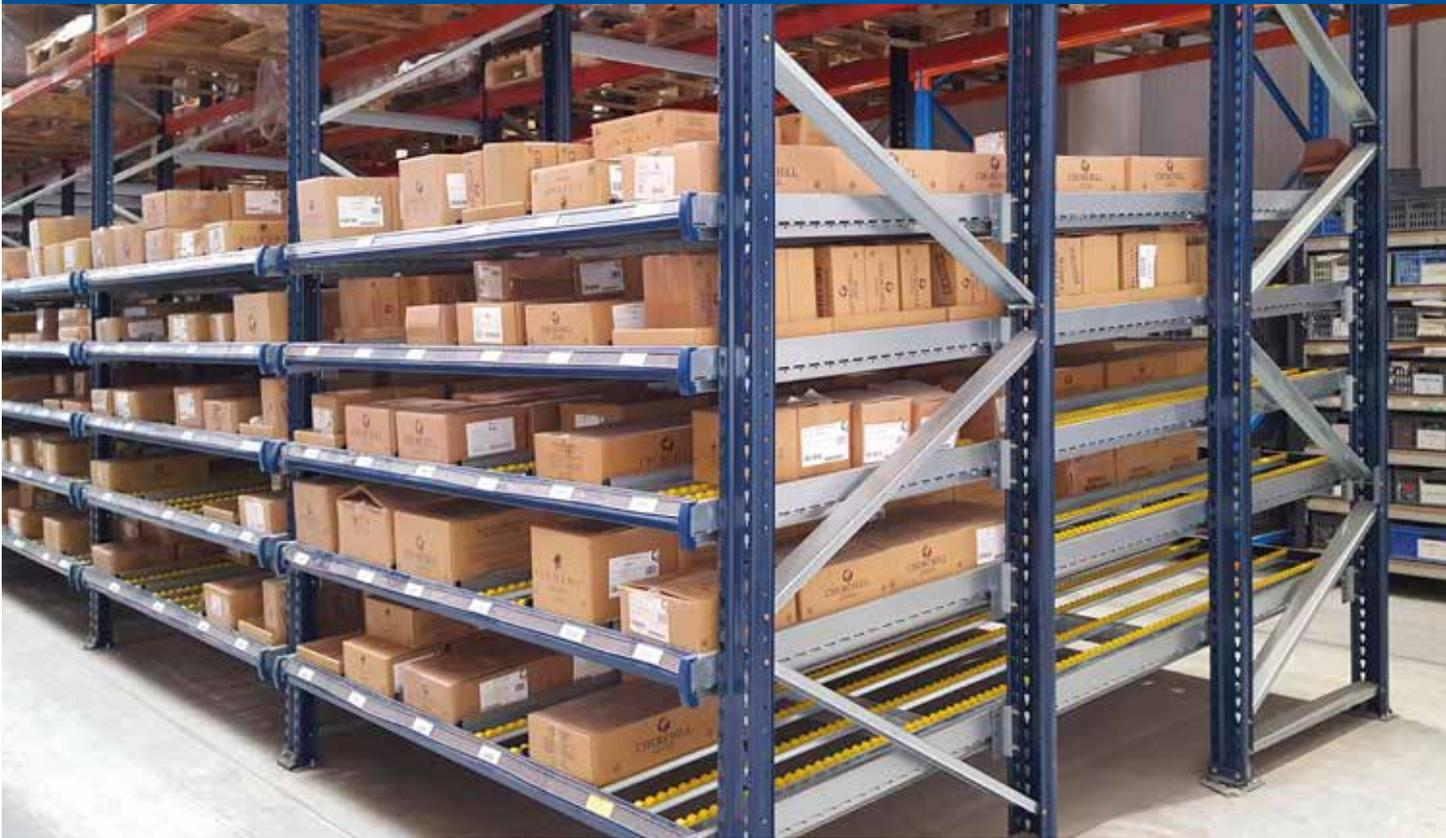
Die Stückgut-Durchlaufregalebenen oder Fachebenen tragen die zu lagernde Ware. Sie sind so konzipiert, dass sie die verschiedenen Bauteile aufnehmen und in den unterschiedlichsten Positionen des Regalfeldes eingebaut werden können. Die Montage gestaltet sich sehr einfach und ebenso leicht können Änderungen und Ergänzungen der Zubehörteile vorgenommen werden.
