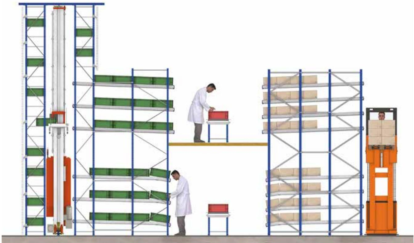
**13.** Hier wird eine Lösung mit Stückgut-Durchlaufregalen, die mit einem Laufgang kombiniert sind, gezeigt. Das linke Regal wird automatisch mit einem Regalbediengerät beschickt. Das rechte Regal wird mit einem Kommissionierstapler, der die Paletten mit der Ware transportiert und in die jeweiligen Ebenen einlagert, bestückt.
