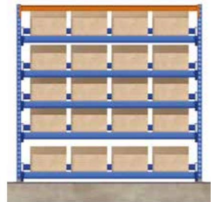
Schema eines herkömmlichen Kommissionierregalsystems mit einem Vergleichsschema eines Stückgut-Durchlaufregalsystems. Die von der Ware belegte Fläche ist in beiden Fällen gleich groß. Beim Stückgut-Durchlaufregal wird durch die Verdichtung der Ware Raum gewonnen. Durch den Wegfall der Gänge mit Zugang in Längsrichtung des herkömmlichen Kommissionierregals kann bis zu 30 % der Lagerfläche eingespart werden.
