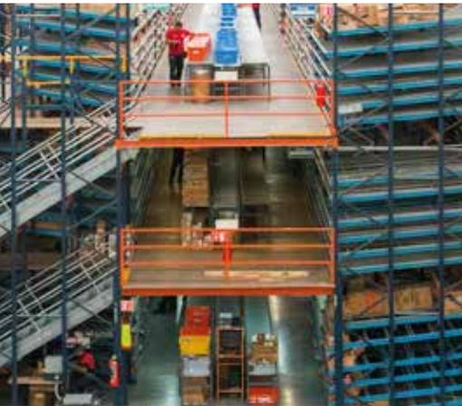
**12.** Diese Lösung zeigt ein Lager mit Stückgut-Durchlaufregalen, die automatisch mit einem Regalbediengerät beschickt werden, das die Höhe des Lagers für den Nachschub nutzt.
