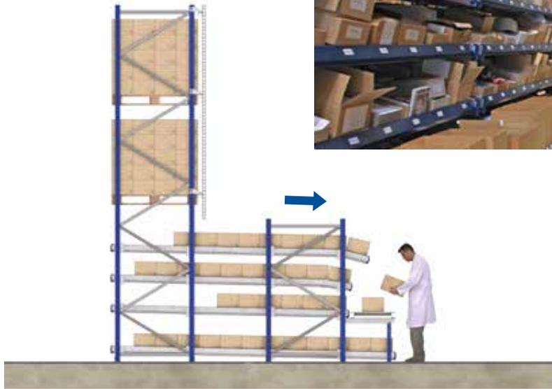
**7.** Auf die Rahmen eines Stückgut-Durchlaufregals wurden hier Ebenen zur Lagerung von Paletten mit Nachschub für die darunter angeordneten Kommissionierebenen geplant.
