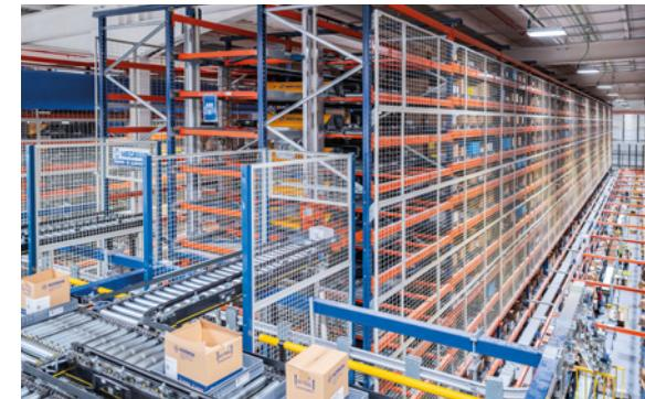
**Das Steuerungssystem von Mecalux verarbeitet Tausende von Daten in Echtzeit, um mehr als 70 Behältertypen automatisch zu bewegen**
