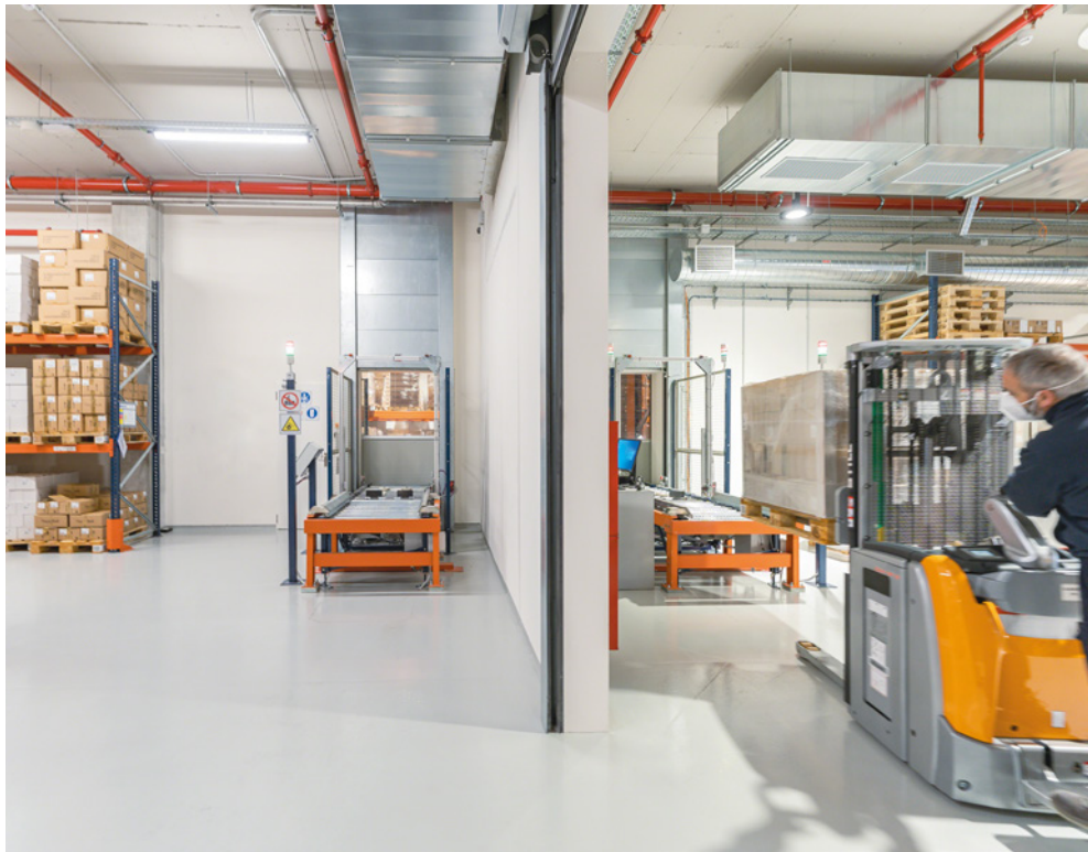
Die Warenein- und -ausgangsstationen des automatisierten Lagers sind reversibel
