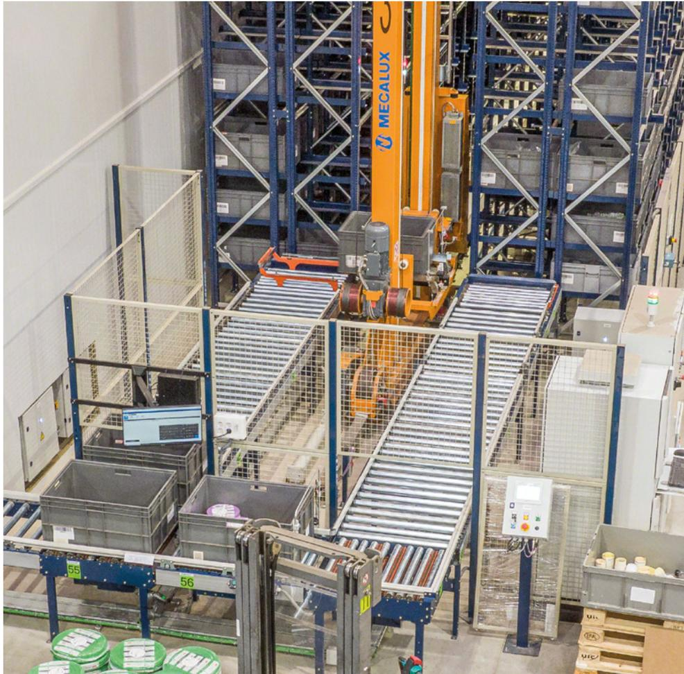
Im automatischen Lager hingegen müssen die Paletten eine Palettenkontrollstation durchlaufen, wo ihre Abmessungen überprüft werden. Wenn die Abmessungen innerhalb des entsprechenden Bereichs liegen, weist Easy WMS die Regalbediengeräte an, sie am zugewiesenen Stellplatz zu platzieren.
