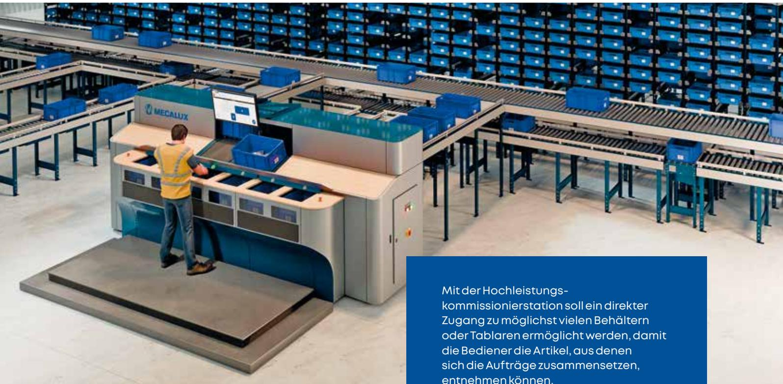
Mit der Hochleistungs-kommissionierstation soll ein direkter Zugang zu möglichst vielen Behältern oder Tablaren ermöglicht werden, damit die Bediener die Artikel, aus denen sich die Aufträge zusammensetzen, entnehmen können.
