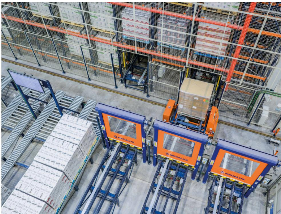
an der Seite des Gebäudes in das automatische Lager befördert. Eine Reihe von FTS befördert die Ware und platziert sie auf dem Palettenfördersystem oder entnimmt sie daraus. Anschließend wird sie von dort aus am automatischen Pallet Shuttle mit Regalbediengerät positioniert. Die Koordination zwischen diesen Systemen ermöglicht einen zu 100 % automatischen Ablauf ohne manuelles Eingreifen.
