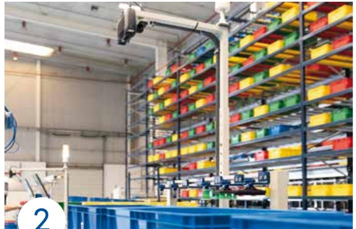
**Identifikation des Produkts.** Die Kamera des Bildverarbeitungssystems macht ein Bild vom Inneren des Behälters, der die Artikelarten enthält. Die Vision Software analysiert dann das Foto, um die Silhouette des zu entnehmenden Produkts zu erkennen und die beste Methode zur Entnahme zu bestimmen.
