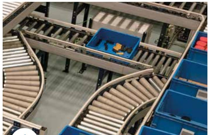
**Kommissionierter Auftrag.** Sobald die Kommissionierung abgeschlossen ist, wird der Auftragsbehälter über das Fördersystem in einen anderen Bereich des Lagers (Konsolidierung, Versand usw.) befördert.
