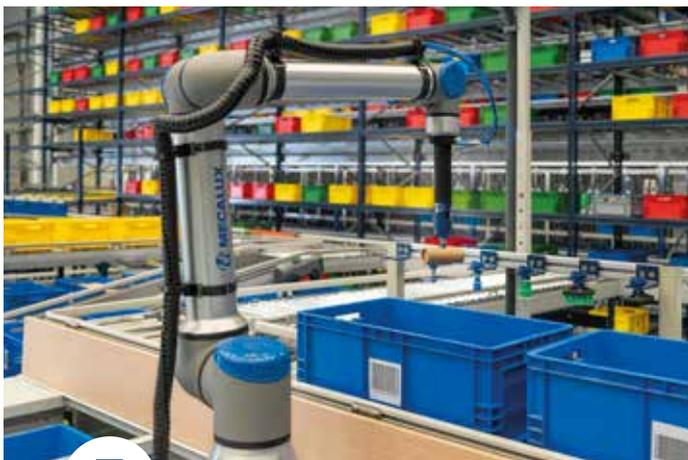
**Aufnahme und Absetzen des Produkts.** Anhand der Daten, die die Siemens-Vision-Software liefert, nimmt der Roboterarm das ausgewählte Produkt auf und setzt es im entsprechenden Auftragsbehälter ab.
