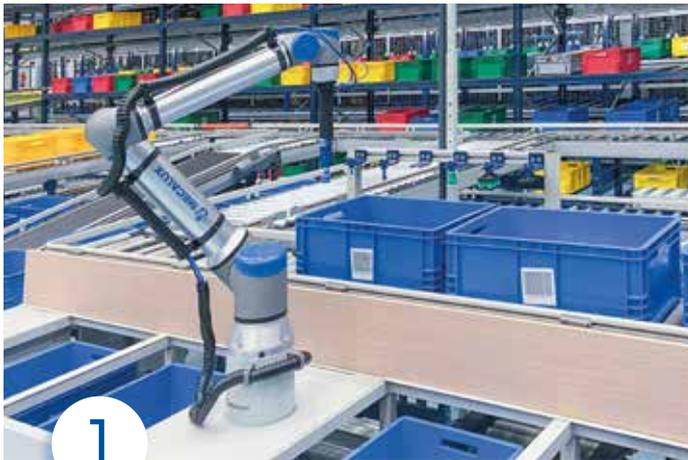
**Ankunft der Behälter.** Das Lagerverwaltungssystem Easy WMS (LVS) sendet einen Behälter mit Artikelarten und einen oder mehrere leere Behälter zur Kommissionierung. Das LVS gibt dem Roboter zudem an, welchen Greifertyp er für die jeweilige Artikelart verwenden soll.
