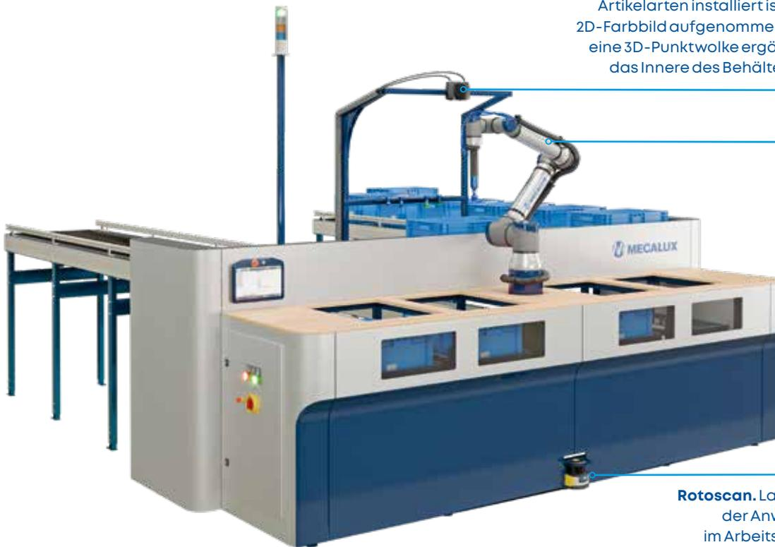
**Kamera.** Hochauflösende Kamera, die über der Position des Behälters mit Artikelarten installiert ist. Es wird ein 2D-Farbbild aufgenommen, das durch eine 3D-Punktwolke ergänzt wird, die das Innere des Behälters darstellt.
