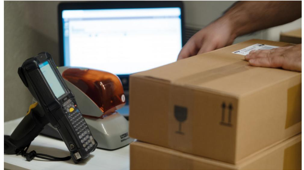
Die Kommissionierer verfügen über Hand-scanner, mit denen sie in Echtzeit mit dem LVS kommunizieren können. Auf diesen Geräten erhalten sie ihre Anweisungen und bestätigen anschließend, dass sie ausgeführt wurden. Es handelt sich um ein sehr agiles System, das die Arbeit der Kommissionierer erleichtert und somit die Leistung deutlich erhöht.
