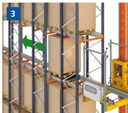
3. Der automatische Wagen hebt die Ladung etwas an und setzt sie in den Lagerkanal. Er bewegt sich mit der Palette bis zur ersten freien Lagerposition, wo er sie absenkt und auf die Schiene setzt.
