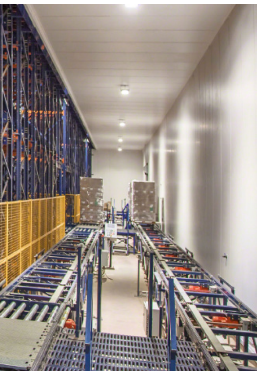
1. Das Pallet Shuttle im Schlitten des Regalbediengeräts wartet auf die Ankunft der Palette aus der Kontrollstation.
