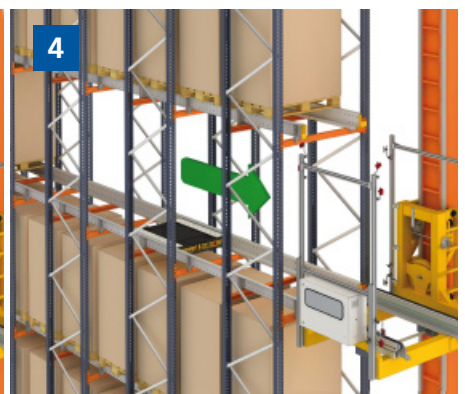
4. Das Regalbediengerät wartet, bis das Pallet Shuttle seine Arbeit beendet hat und wieder automatisch in den Schlitten fährt.
