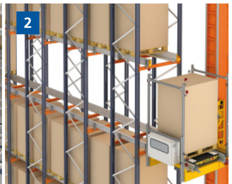
2. Das Regalbediengerät holt die Palette mithilfe von im Schlitten vorhandenen Ketten ab und fährt zu dem vom LVS zugewiesenen Kanal.
